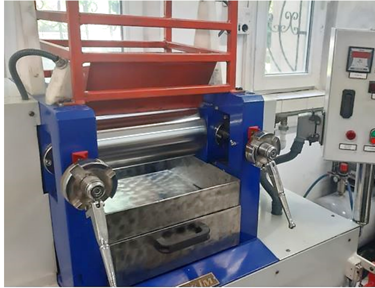
Şekil 3. 1. P(ECH-ko-EO-ko-AGE) hamurlarının hazırlanmasında kullanılan açık mil sistemi.
