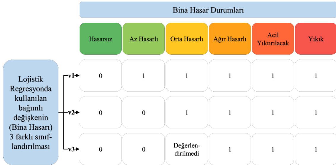
Şekil 5.5. Bina hasar durumlarının 3 farklı şekilde sınıflandırılması
