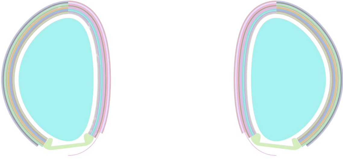
Şekil 3.1 Demo füzyon reaktörünün 3 boyutlu şeması: eksenel
