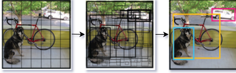
Şekil 2.12 YOLO' nun çalışma prensibi (Redmon vd. 2016)
