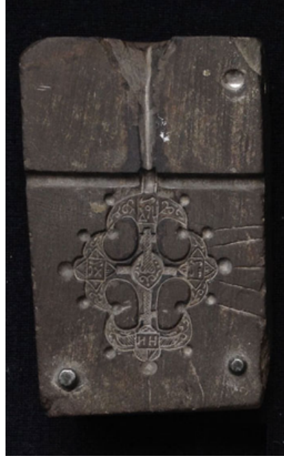
Resim 53: Haç dökümü için taş kalıp. Üst kısımda ters T şeklinde ve kalıbın sol kenarında 5 ince döküm alaşımının akış kanallarının görüldüğü taş kalıp. (Dr. Sergey A. Afonin Arşivi, St. Petersburg).
