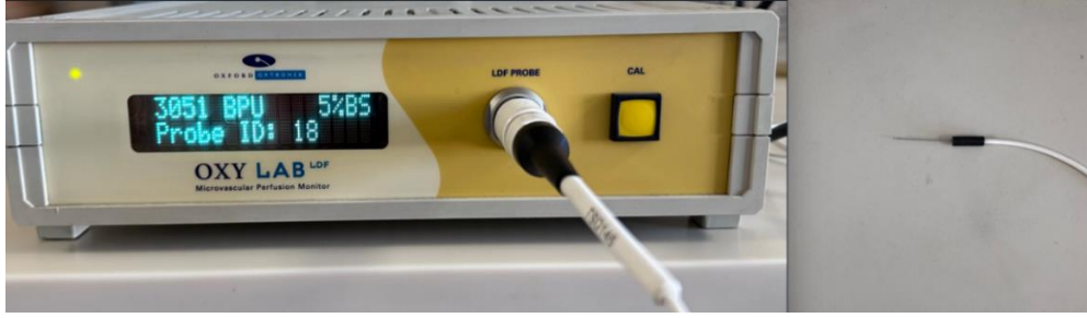
Şekil 3.3. Böbrek perfüzyon değişimi ölçümünde kullanılan cihaz ve prob. OxyLab Mikrovasküler Perfüzyon Monitörü ve eritrosit röfle miktarına duyarlı doku probu (TSD145, BioPac).
