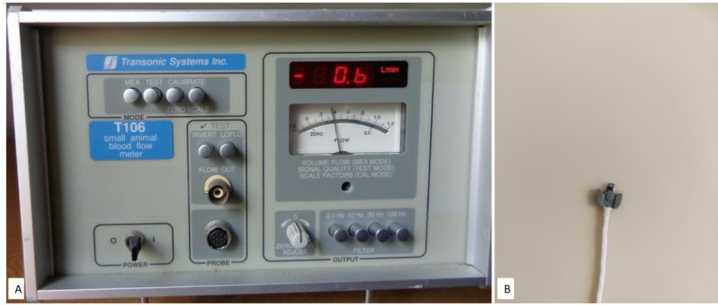
Şekil 3.2. Kan akımı ölçümünde kullanılan cihaz ve prob. Transonic Systems T106 küçük hayvan kan akım ölçer (Small Animal Blood Flow Meter) (A). Damar probu, Perivascular Flow Probes, Transonic Systems (B).
