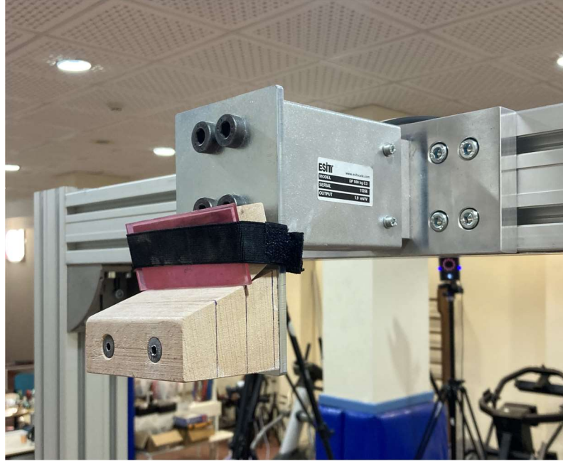
Şekil 3.5 Tutamak, bağlantı plakaları ve yük hücresi
