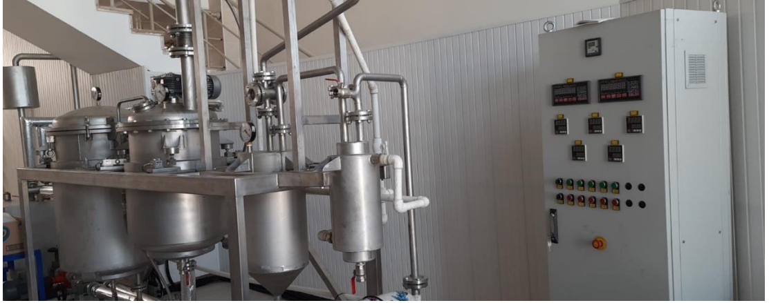
Şekil 4.11. Pilot ölçekli üretim denemelerinde kullandığımız endüstriyel solvent ekstraksiyon makinesi
