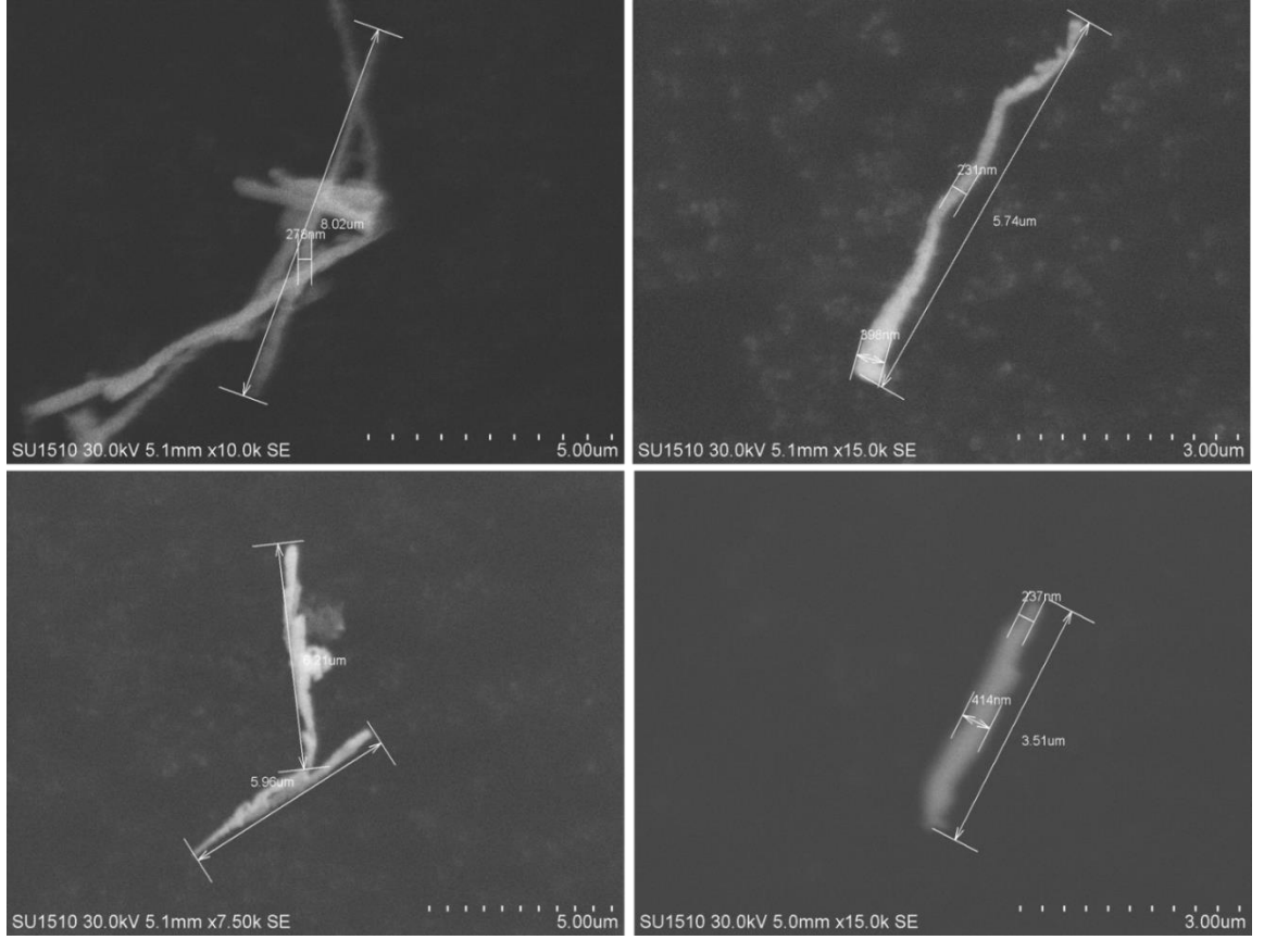
Şekil 4.17. Polimerik tabaka temelli tel (çubuk) şeklindeki motorların SEM görüntüleri
