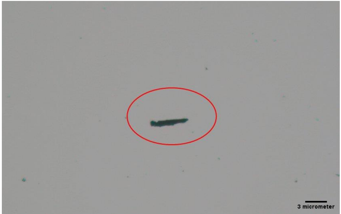
Şekil 4.14. Yıkama aşamalarından sonra membrandan ayrılmış olan tel şeklindeki polimerik yapılara ait optik mikroskop görüntüsü
