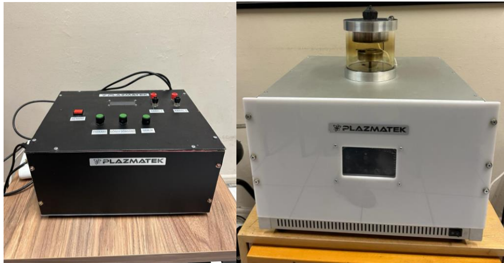
Şekil 3.1. Alümina membranları Ag ile kaplamak için kullanılan Püskürtme Cihazı (Sputter) Bileşenleri
