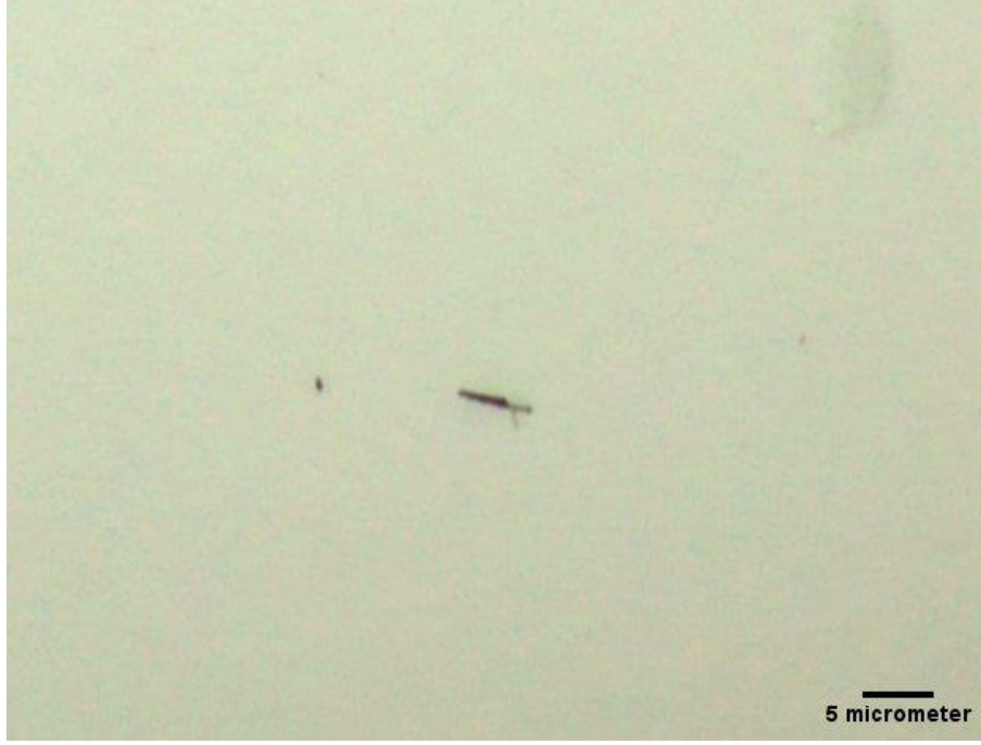
Şekil 4.11. İyi yıkanmamış bir nanomotora ait optik mikroskop görüntüsü.
