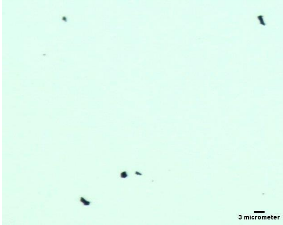
Şekil 4.11. İyi yıkanmamış bir nanomotora ait optik mikroskop görüntüsü.
