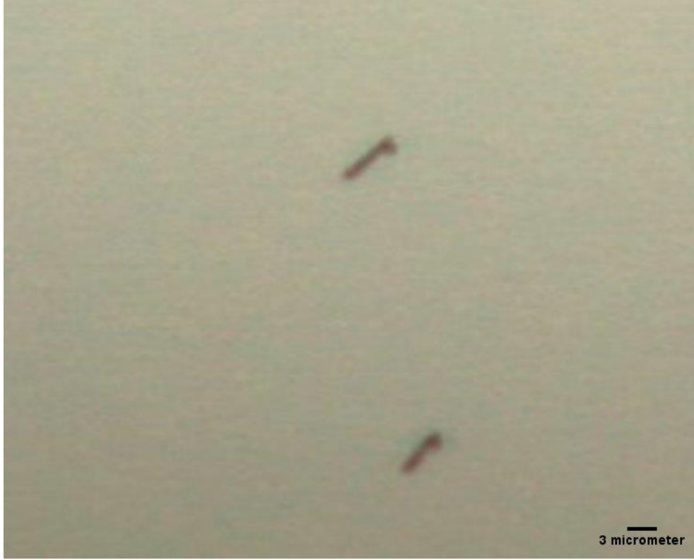
Şekil 4.15. Polimerik tabaka 20 döngüde dönüşümlü voltametri ile hazırlandığında elde edilen nanomotora ait optik mikroskop görüntüsü.
