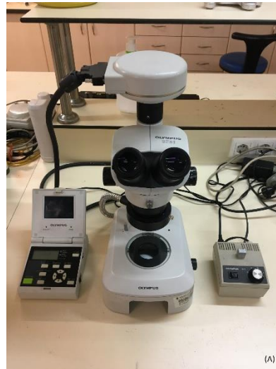
Şekil 3.6. Hacettepe Üniversitesi AR-GE Laboratuvarında bulunan Olympus SZ61 stereo mikroskop ve mikroskoba bağlı kamerası Olympus DP12 (Olympus, Tokyo, Japonya) (A), Etüv Fırını (B)
