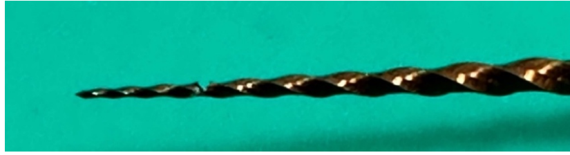
Şekil 3.1. Elmas separe disk ile yarı derinliğine kadar çentik oluşturulan 25.06 numaralı döner eğesi
