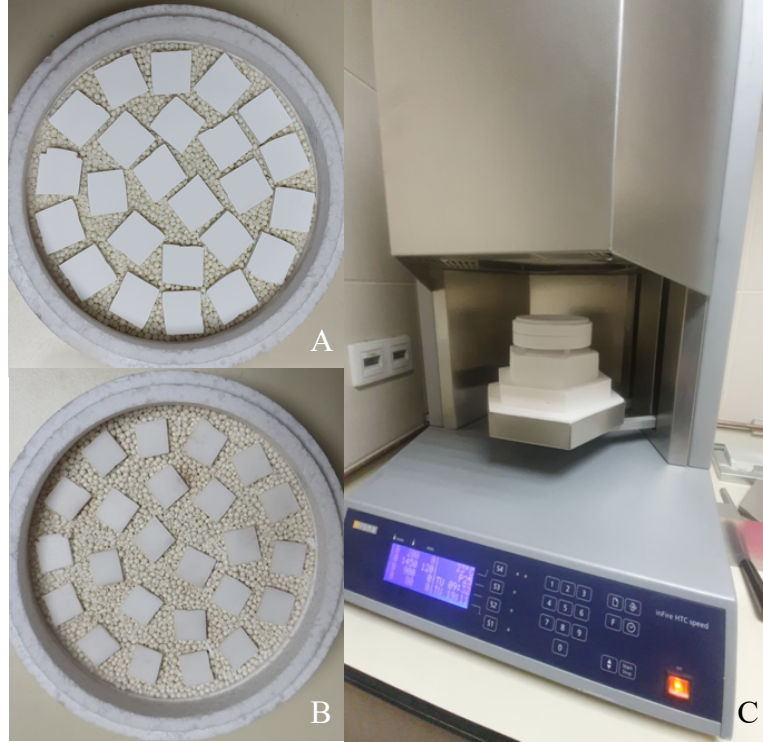
Şekil 3.3 Zirkonya altyapıların sinterleme işlemi (A) ve sonrası (B) görünümü ve sinterleme işlemi için kullanılan fırın (C)
