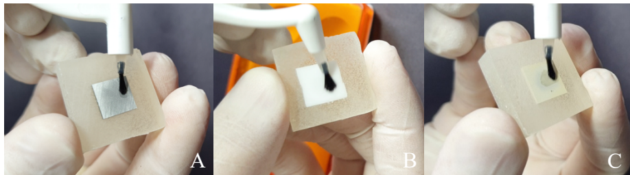
Şekil 3.9 Titanyum (A), zirkonya (B), modifiye PEEK (C) alt yapılar için primer uygulaması
