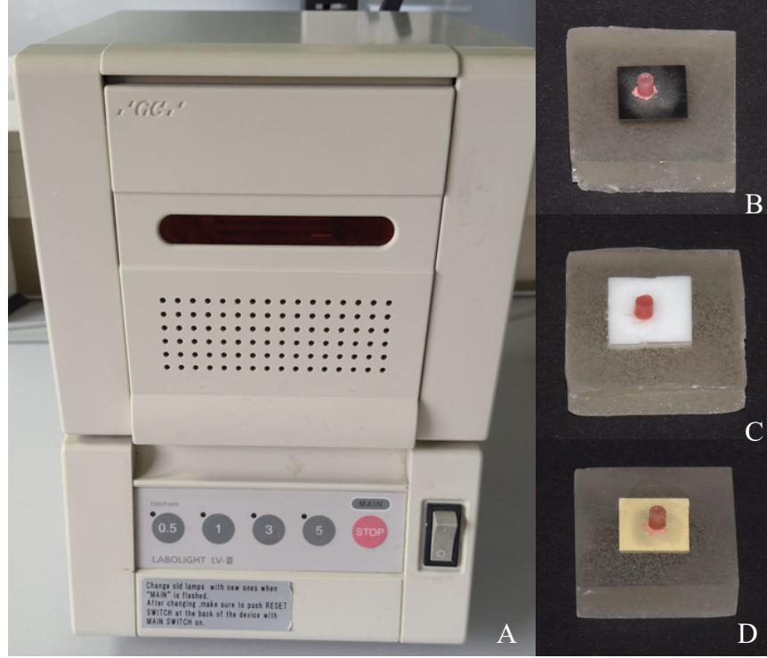
Şekil 3.14 Çalışmada kullanılan laboratuvar tipi ışık cihazı (A) ve yapım süreci bitmiş titanyum (B), zirkonya (C), modifiye PEEK (D) örnek
