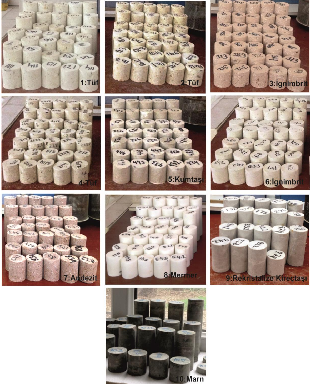
Şekil 5.1. UCS deneyi için hazırlanan farklı L/D oranlarındaki örnekler.
