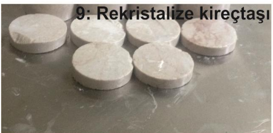
Şekil 5.7. BPI deneyi için hazırlanmış ve deney yapılmış örneklerden görünümler.
