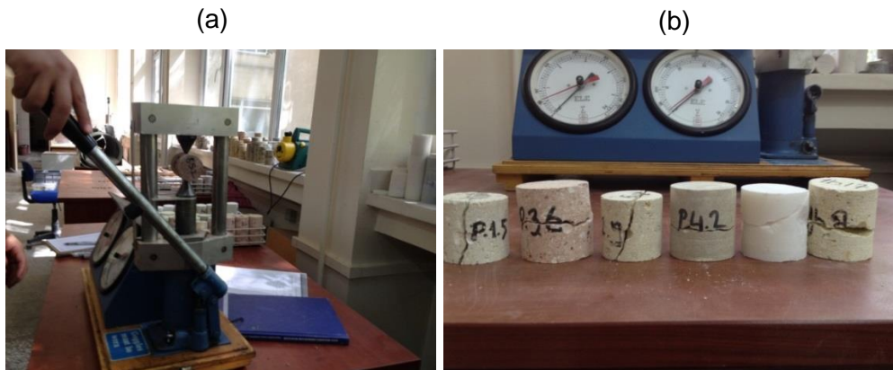
Şekil 5.6. (a) Nokta yüğü dayanımı deneyinin çapsal olarak andezit numunesi üzerinde uygulanması ile (b) nokta yükleme dayanımı deneyi uygulanmış kaya örneklerinden görünümüler.
