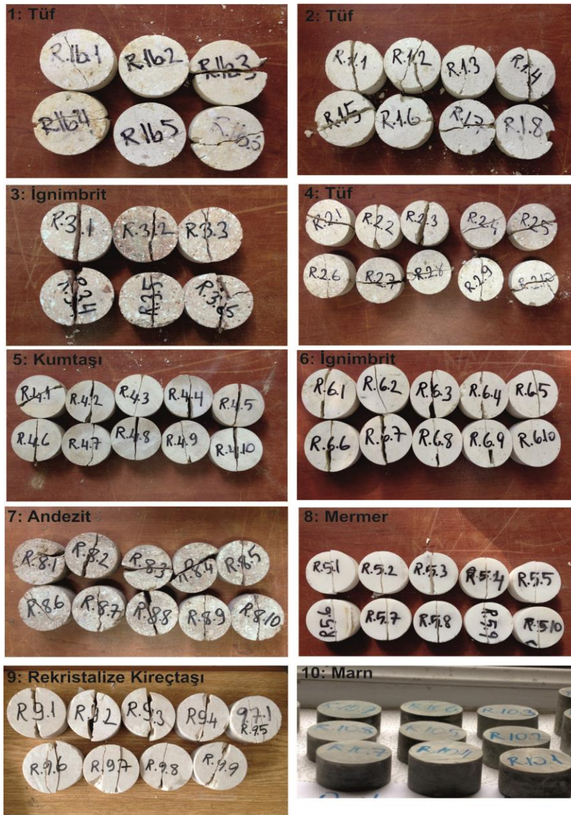
Şekil 5.5. Brazilian deneyi sonrasında yenilmiş örnekler.
