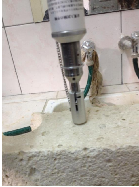
Şekil 5.8. Blok örneklerden birinde yapılan iğne penetrometre deneyinden (NPT) bir görünüm.
