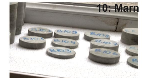
Şekil 5.7. BPI deneyi için hazırlanmış ve deney yapılmış örneklerden görünümler.
