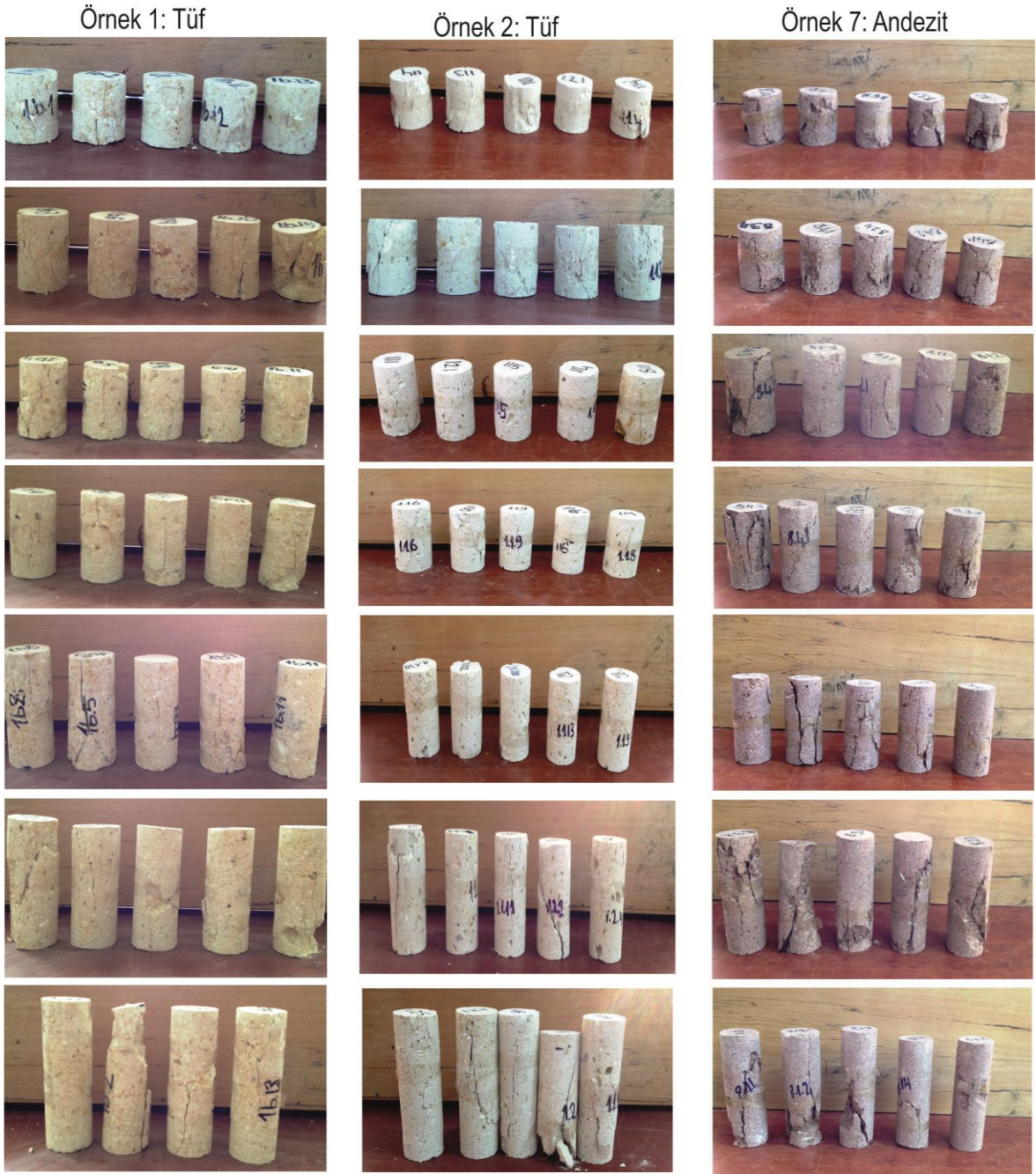
Şekil 5.3. L/D=1.0-3.0 arasında değişen örnekler üzerinde yapılmış UCS deneylerine ait seçilmiş görünüşler.
