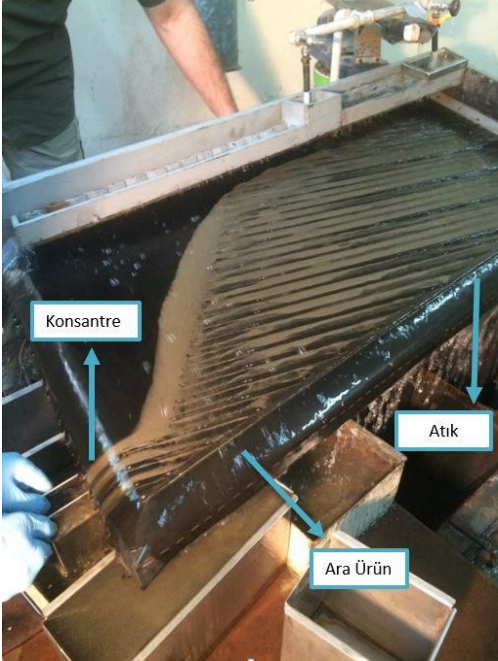
Şekil 3.22 Akarşen sekonder değirmen çıkışına yapılan sallantılı masa testlerinden bir görüntü
