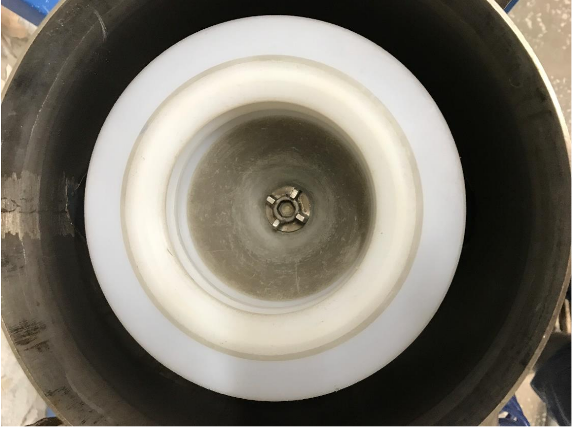
Şekil 3.3 Falcon L40 zenginleştiricisinin iç kısmının üstten görünümü
