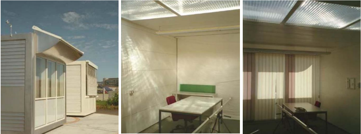
Görsel 63. Anidolik Uygulama Yapılmış Test Odası. (Okutan, 2008)
