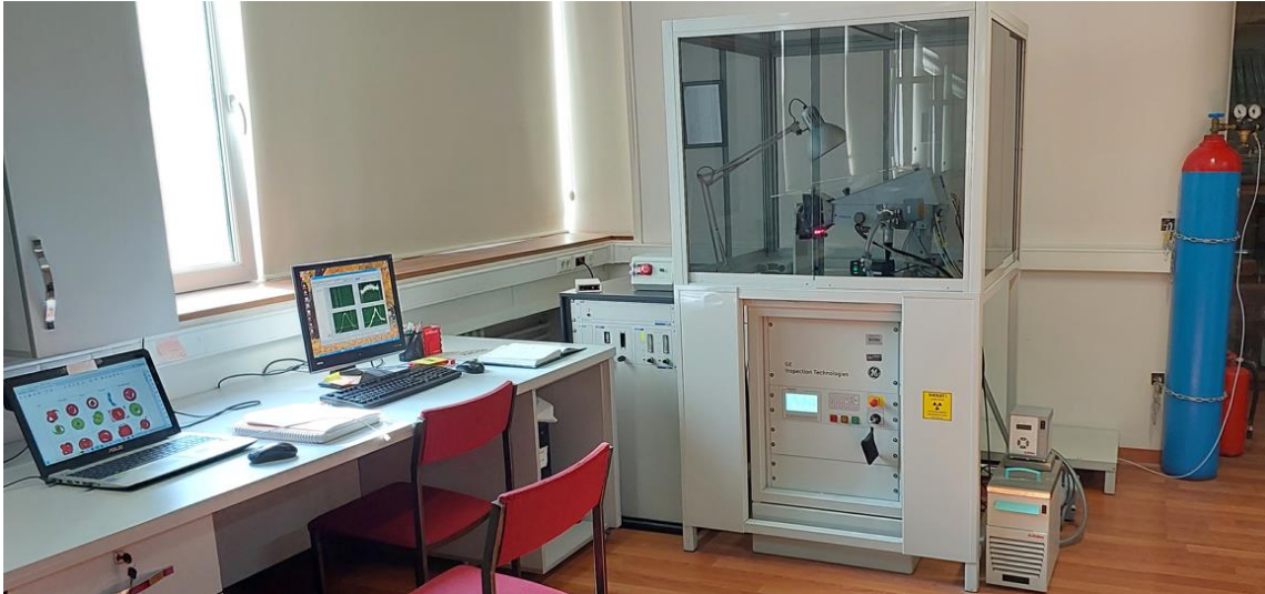
Şekil 4.1. Hacettepe Üniversitesi, Fizik Müh. Bölümü, X-Işınları Laboratuvarı'ndaki HECUS tipi SWAXS sistemi
