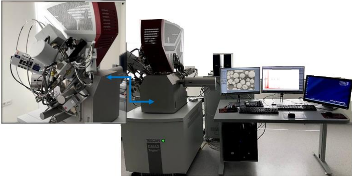
Şekil 4.17. HÜNİTEK'te bulunan Tescan marka GAIA3 model SEM ve Oxford XMax 150 model EDS.
