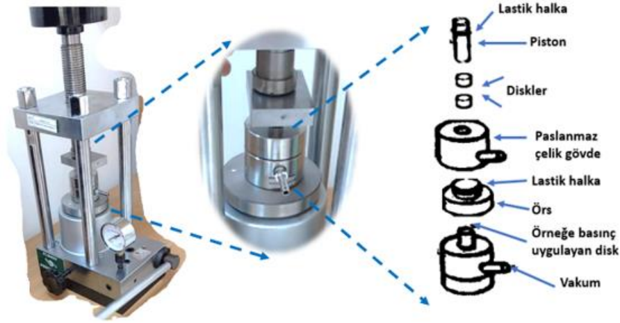
Şekil 4.19. Pres makinesi ve pelet hazırlama aşamaları
