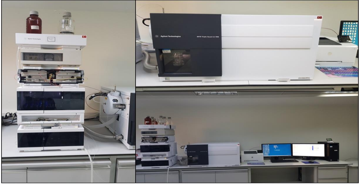
Şekil 3.1. Deneysel çalışmalarda kullanılan Sıvı Kromatografisi-Kütle/Kütle Spektrometresi (LC-MS/MS) cihazı.
