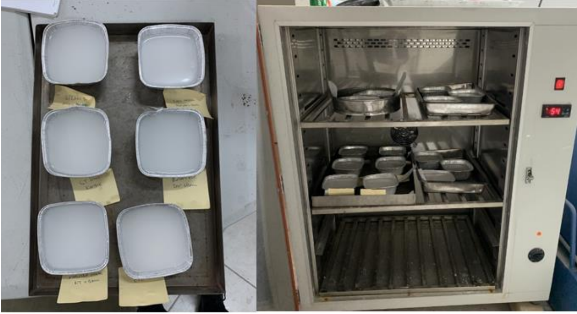
Şekil 3.4. Numune örneklerinin fırına koyulması.
