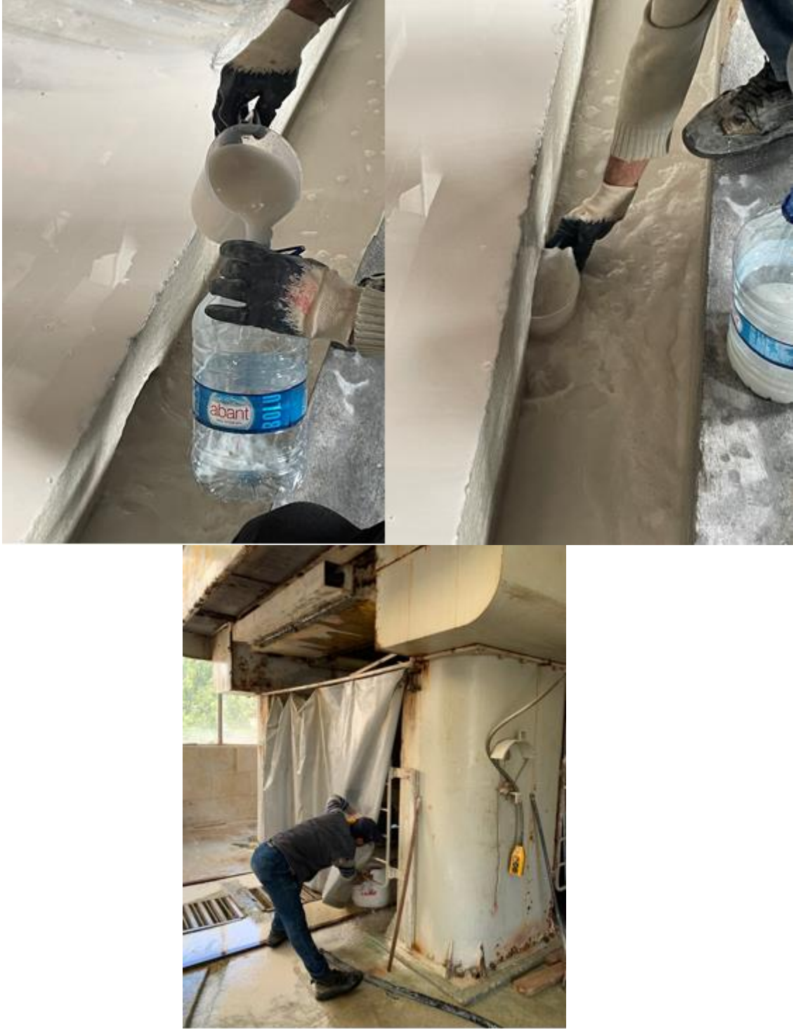
Şekil 3.7. Katraktan numune alımı.
