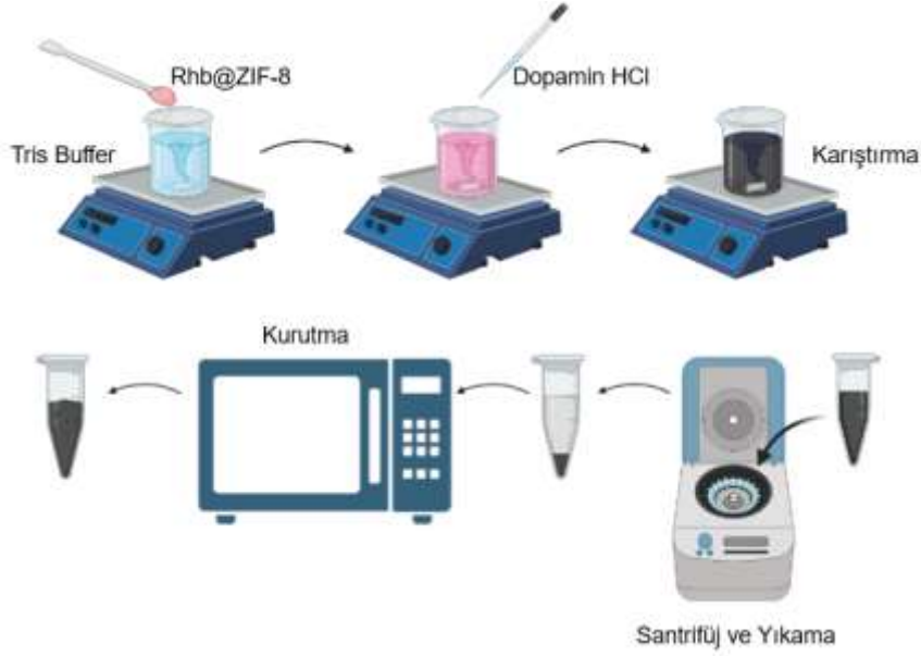
Şekil 3.2. Rodamin-b yüklü ZIF-8'e polidopamin kaplamasının şematik gösterimi
