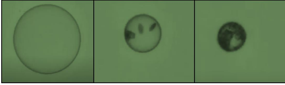
Şekil 2. DMF çözücüsünün silikon yağına geçmesi sonucu öncü çözelti damlacığının küçülmesi, derişiminin artması sonucu aşırı doygun hale gelmesi ve kristalleşmenin başlaması.
