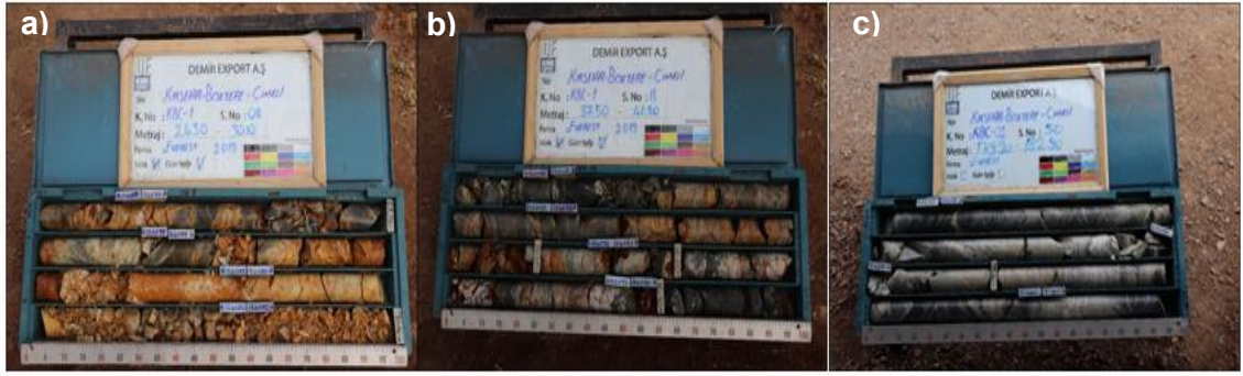
Şekil 5.2. Zonlara ait karot görüntüleri a) oksitli zona ait karotlar b) geçiş zonuna ait karotlar c) sülfürlü zona ait karotlar
