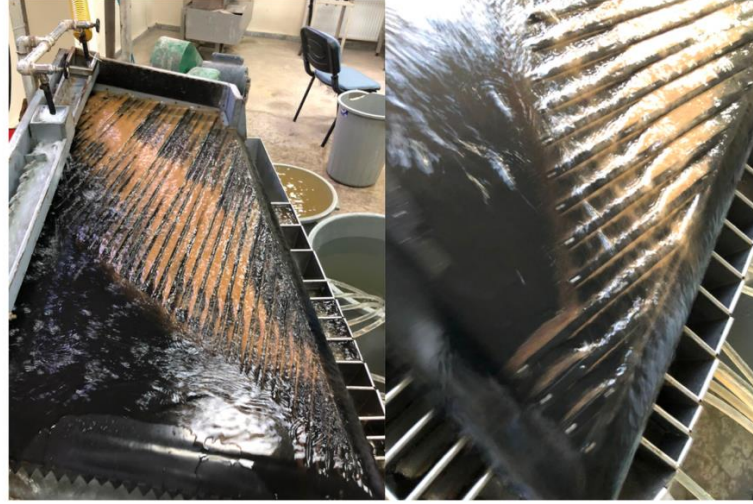
Şekil 5.5. Oksitli zon sallantılı masa testi
