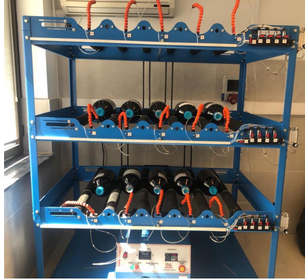
Şekil 5.4. Şişe çevirme test düzeneği
