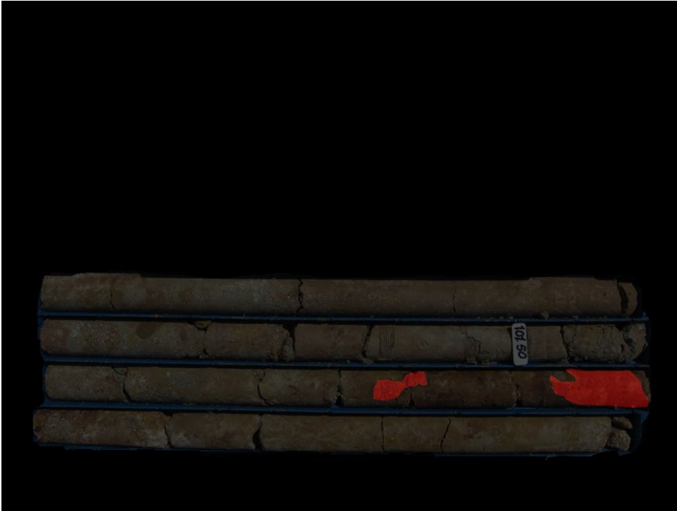
Şekil 4.10. Numunedeki cevherli bölgenin tespiti için etiketlenmiş görüntü örneği.
