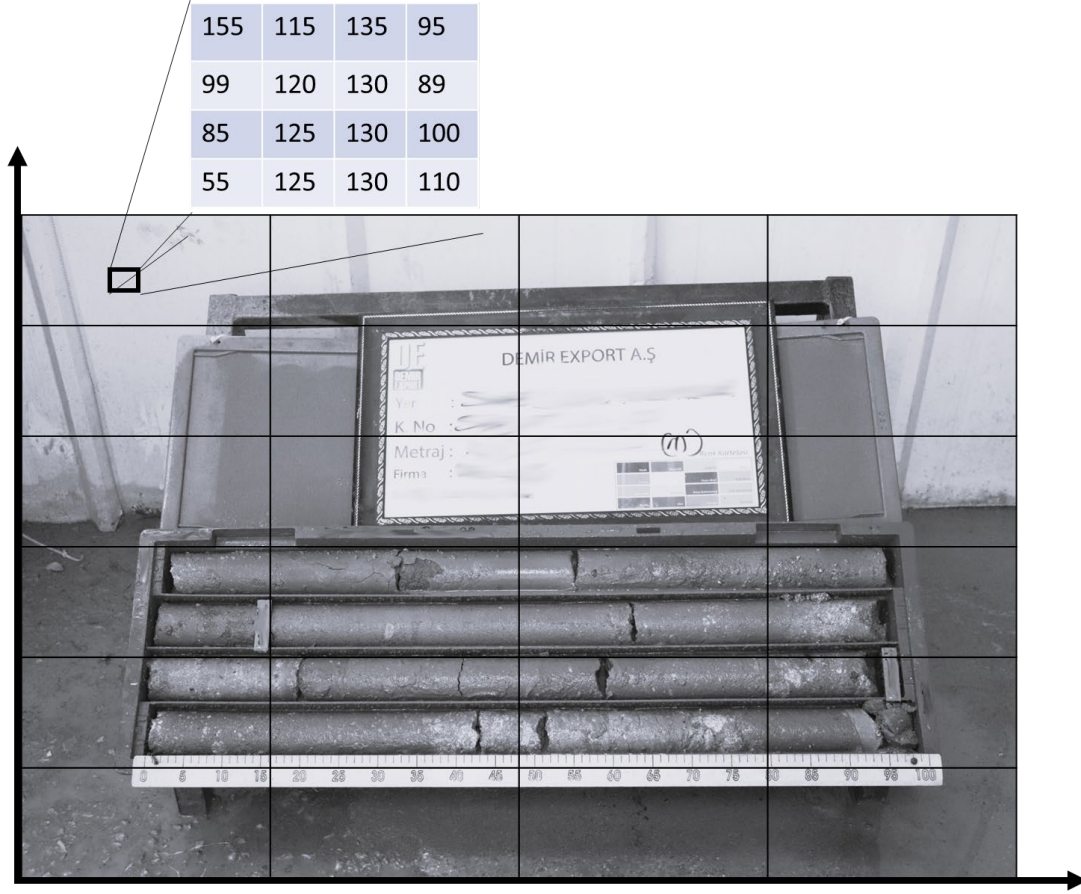
Şekil 2.1. Tek renk kanalına sahip görüntü ve görüntü de bir parçanın matris gösterimi.
