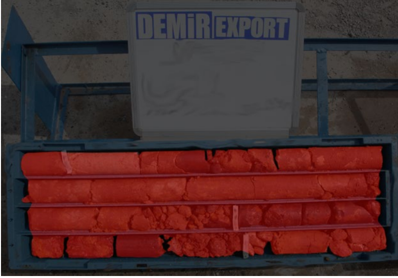
Şekil 4.9. Karot sandığı içerisindeki numunenin tespiti için etiketlenmiş görüntü örneği.
