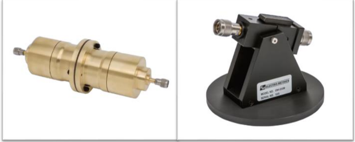
Şekil 3.18 EM kalkanlama test fikstürleri EM-2107A (Electro-Metrics, 2023a) solda ve EM-2108 (Electro-Metrics, 2023b) sağda
