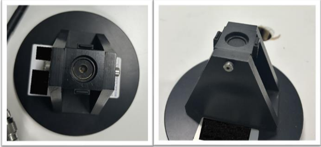
Şekil 3.20. 1,5-10 GHz için örnek ve test fikstürü
