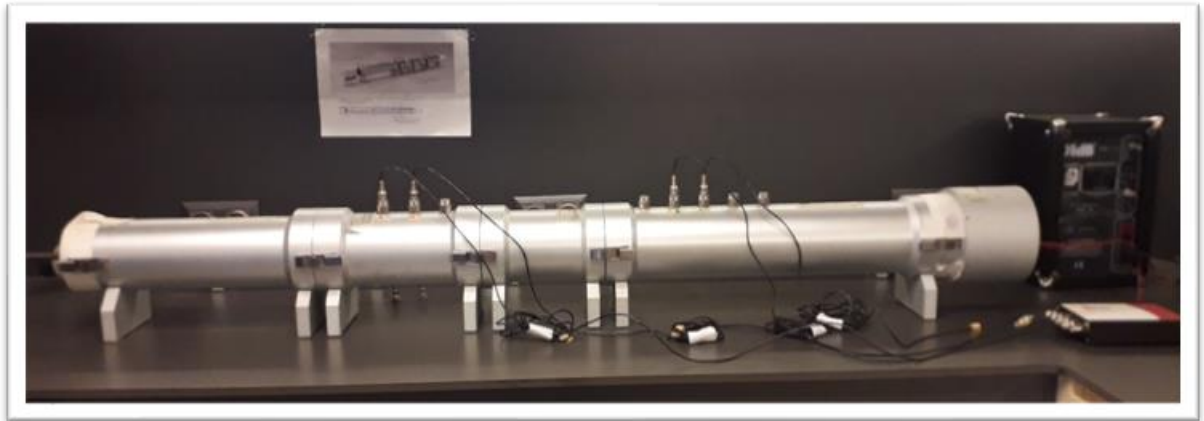
Şekil 3.15. Ses iletim kaybı ölçümünde kullanılan empedans tüpü
