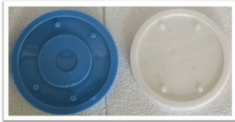
Şekil 3.8. EMI testi için üretilen silikon kalıplar (30 MHz-1,5 GHz)
