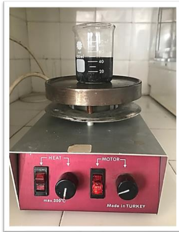
Şekil 3.6. GNP ve epoksinin manyetik karıştırıcıda karıştırılması
