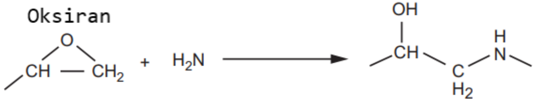
Şekil 4.6. Oksiran halkasının aminle açılma mekanizması
