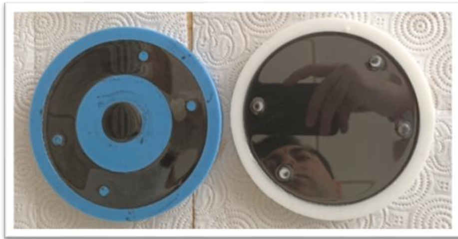
Şekil 3. 11. 30 MHz-1,5 GHz EMI testi için hazırlanan örnekler
