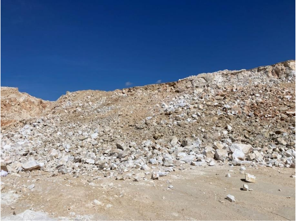
Şekil 3.10. Saha 1 - 1. patlatma sonrası – Tek yemleme
