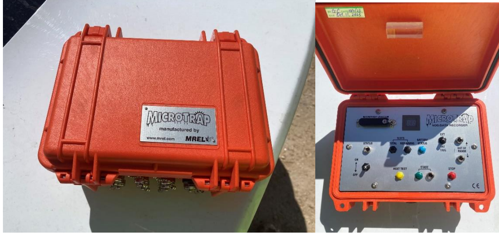
Şekil 3.5. Microtrap VOD (İnfilak Hızı) ölçüm cihazı
