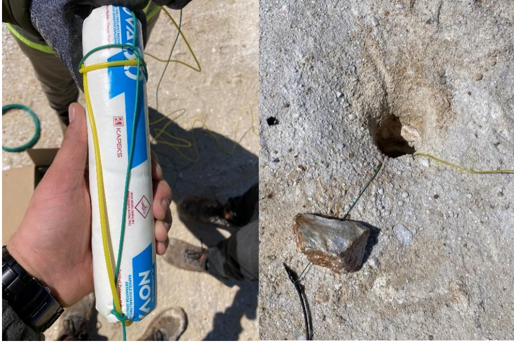
Şekil 3.7. Dinamit-prob bağlantısı (solda), delik içine yerleştirilmiş hali (sağda)
