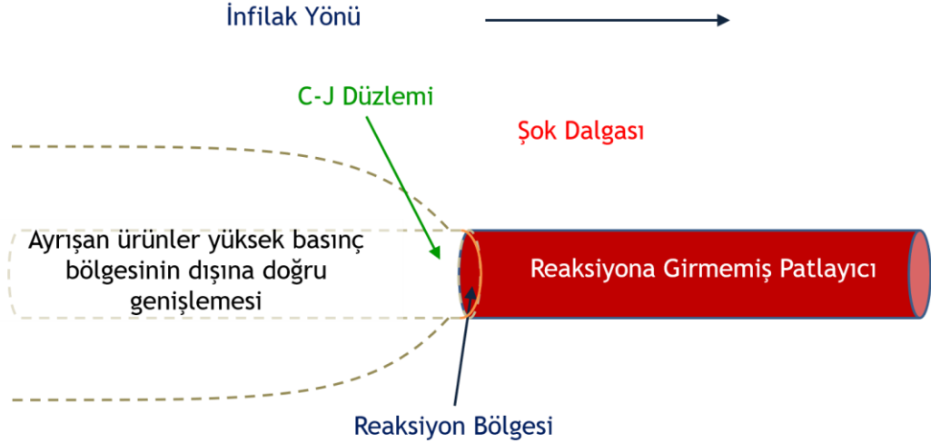
Şekil 2.14. Delik içi infilak mekanizması [20]
