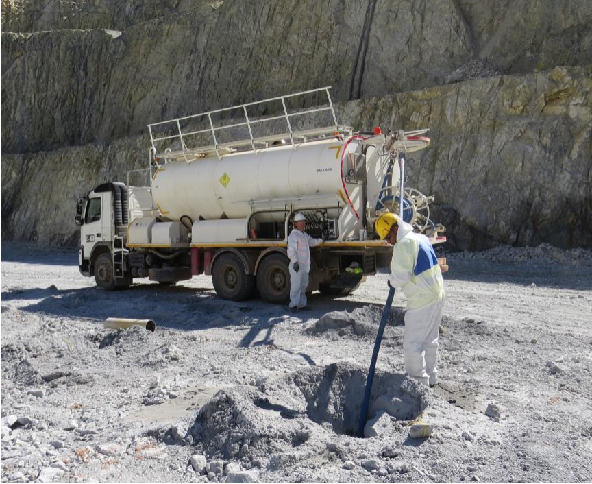
Şekil 2.5. Yemlemeye duyarlı dökme emülsiyon şarj kamyonu (Bulk) [16]
