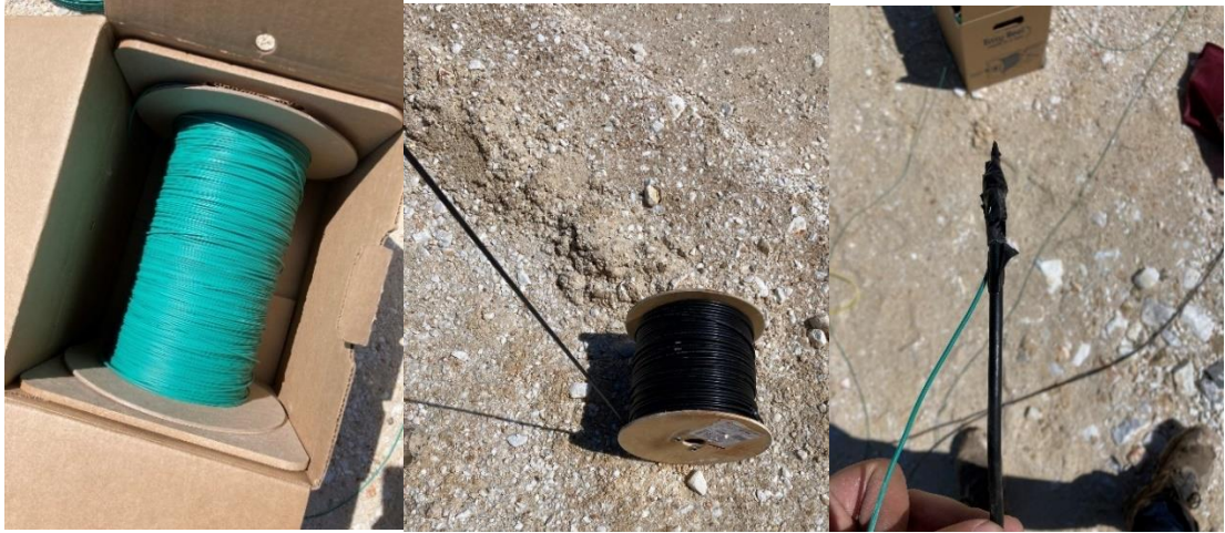
Şekil 3.6. Direnç kablosu (prob) (solda), cihaz bağlantı anten kablosu (ortada), anten kablosu-prob bağlantısı (sağda)
