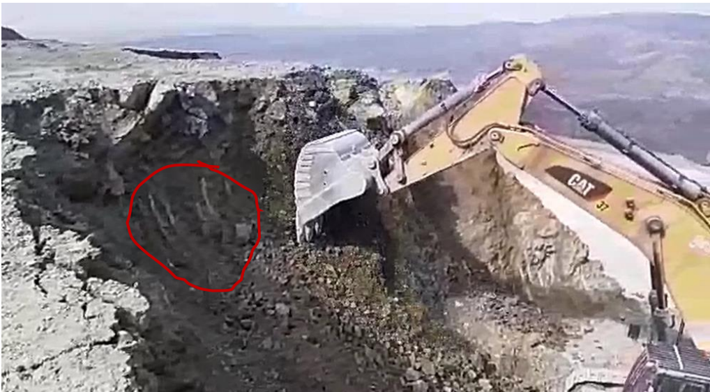
řekil 5.2. 520-1 numaralı patlatma sonrası sıkıřık yıđın formu
