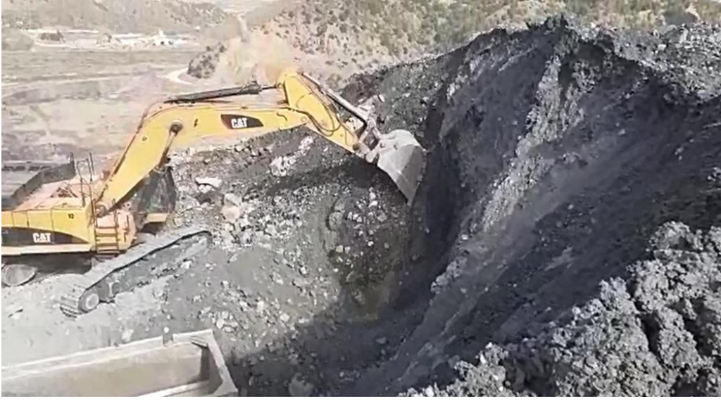
Şekil 5.3. 520-3 numaralı patlatma sonrası gevşek yığın formu
