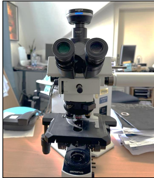
Resim 1: Olympus® BX51 U-MDOB3 model 9C00580 seri numaralı ışık mikroskobu
