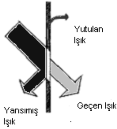
Şekil 44. cam üzerine düşen ışığın hareket yönü (MANAV, KUTLU, & KÜÇÜKDOĞU, 2009, s. 2).
