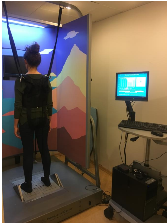
řekil 3.2. ‘ Neurocom Smart Balance Master System ’ Bilgisayarlı Dinamik Postürografi.
