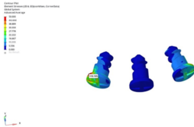
Şekil 4.29. DDY modelinde infrazigomatik plaklar ve mentonplak üzerinden elastik kullanımıyla maksiller protraksiyon modelinde kullanılan mini vidaların Von Missesgerilme görüntüsü
