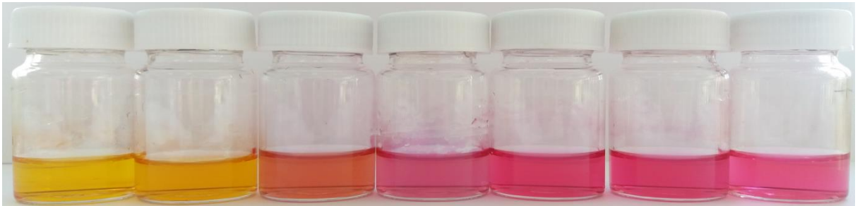
Şekil 4.11. pH 8'de 5-Br-PADAP ile Zn(II) çözeltilerinin etkileşimi ve renk deęişikliği (sırasıyla 5-Br-PADAP ve 0,1 mg/L, 0,5 mg/L, 1 mg/L, 5 mg/L, 10 mg/L ve 20 mg/L Zn(II) Deney Koşulları; çözelti hacmi: 5 mL Zn(II) ve 2 \times 10^{-3} mol/L 5-Br-PADAP, pH:8)
