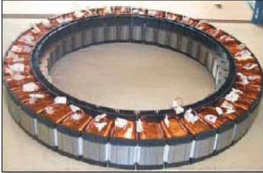
Şekil 2.20. Chung'un tasarımı statorleri ve rotorları montajlanmış jant içi motoru görüntüsü [8]
