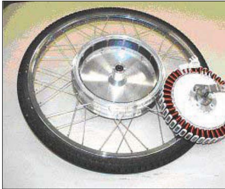
Şekil 2.17. Tipik Bir Bisiklet İçin Uygulanan Jant İçi Elektrik Motoru Uygulaması [8]
