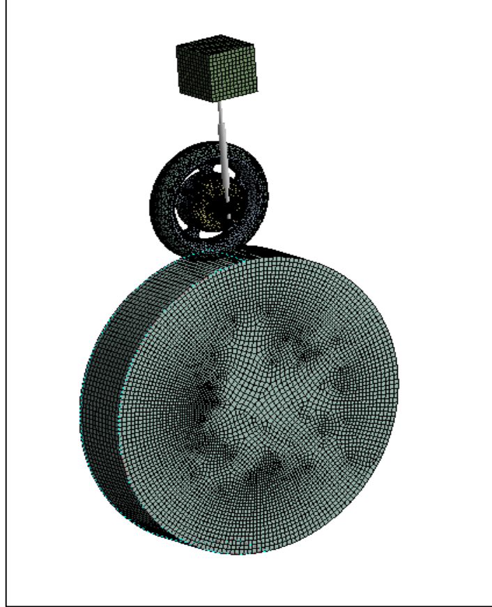
Şekil 5.28. Düz Yol Modeli Genel ve Ağ Yapısı Görüntüsü
