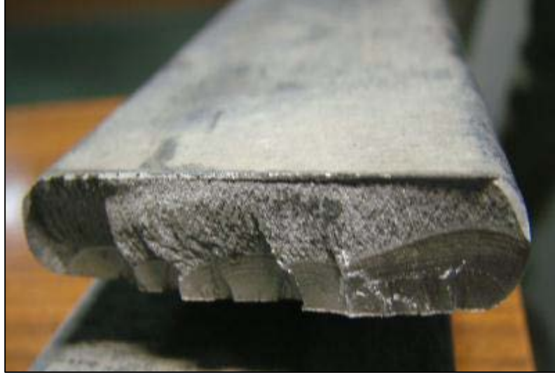
Şekil 3.4. Yorulma Kırığı Yüzey Görüntüsü [17]
