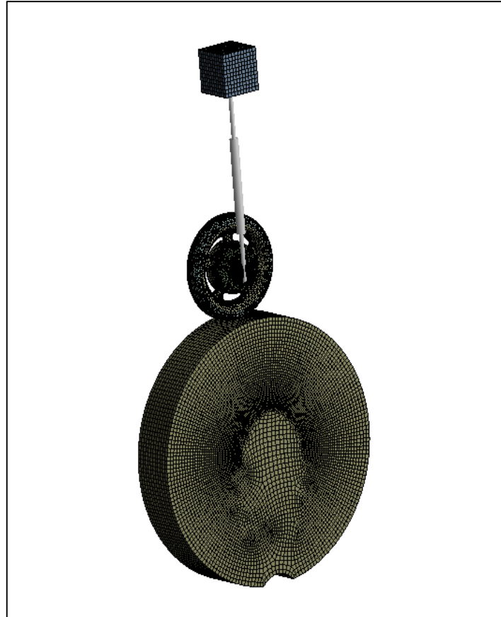
Şekil 5.42. Çukurlu model genel ve ağ yapısı görüntüsü
