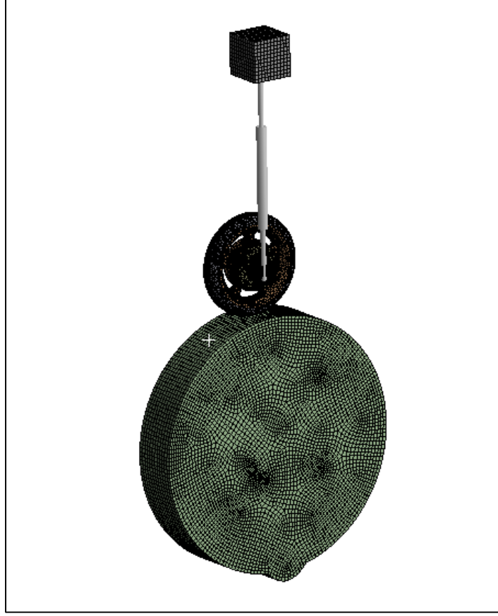
Şekil 5.21. Kasisli model genel ve ağ yapısı görüntüsü
