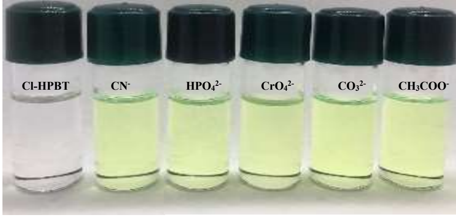
Şekil E2.1. ACN-DMSO (2:8 v/v) ile seyreltilmiş Cl-HPBT ile \text{CN}^- , \text{HPO}_4^{2-} , \text{CrO}_4^{2-} , \text{CO}_3^{2-} ve \text{CH}_3\text{COO}^- ( 2 \times 10^{-2} M, 15 \mu\text{L} ) iyonlarının etkileşimi sonucu elde edilen (a) absorpsiyon spektrumları ve (b) renk değişimi (2 eş değer)
