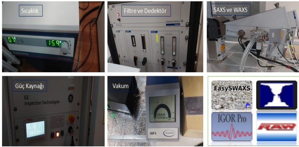
Şekil 3.2. HECUS System3 SWAXS sistem bileşenleri [42, 43].
