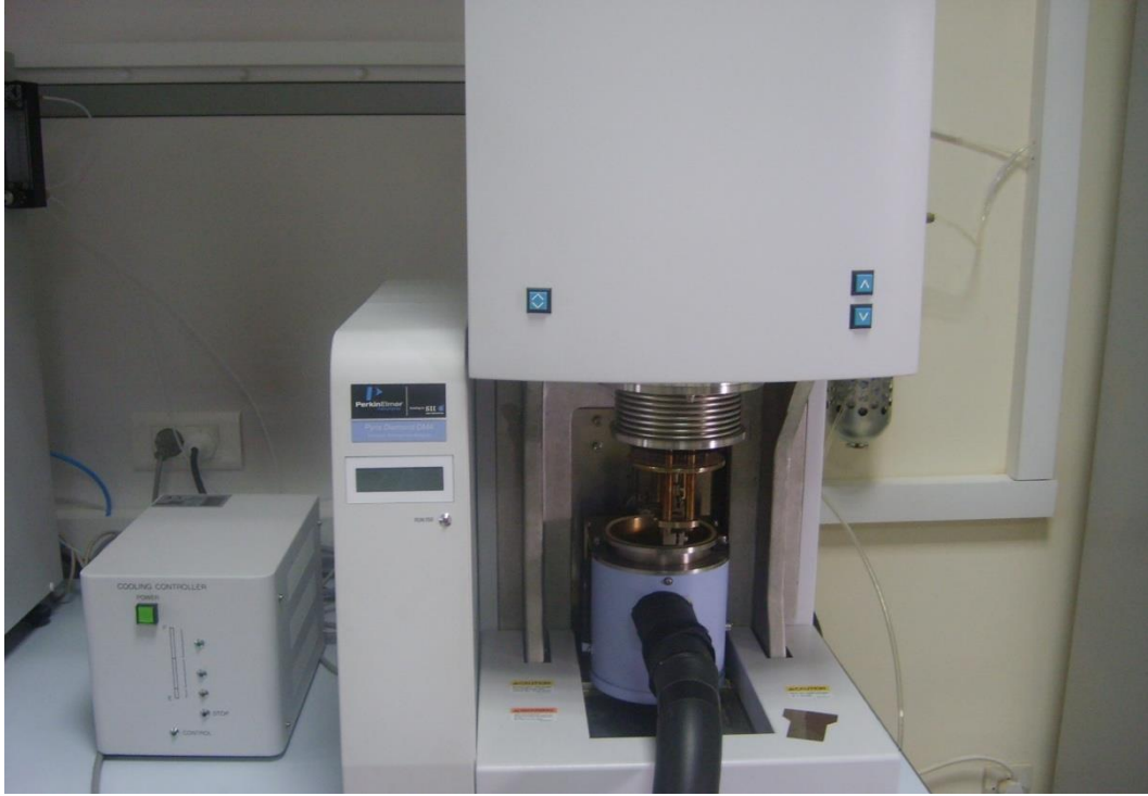
Şekil 3.10. Perkin Elmer Pyris Diamond Dinamik Mekanik Analiz Cihazı
