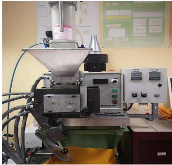
Şekil 3.1. Laboratuvar tipi dahili karıştırıcı
