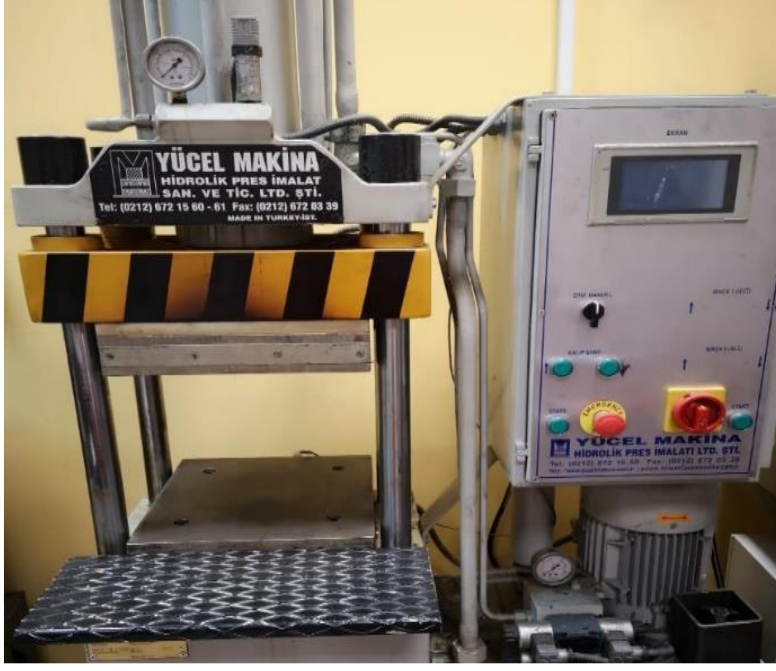
Şekil 3.3. Laboratuvar tipi hidrolik sıcak pres
