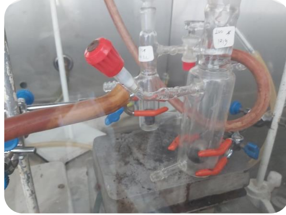
Şekil 3.1. Metatez tepkimeleri gerçekleştirilirken kullanılan örnek düzenek
