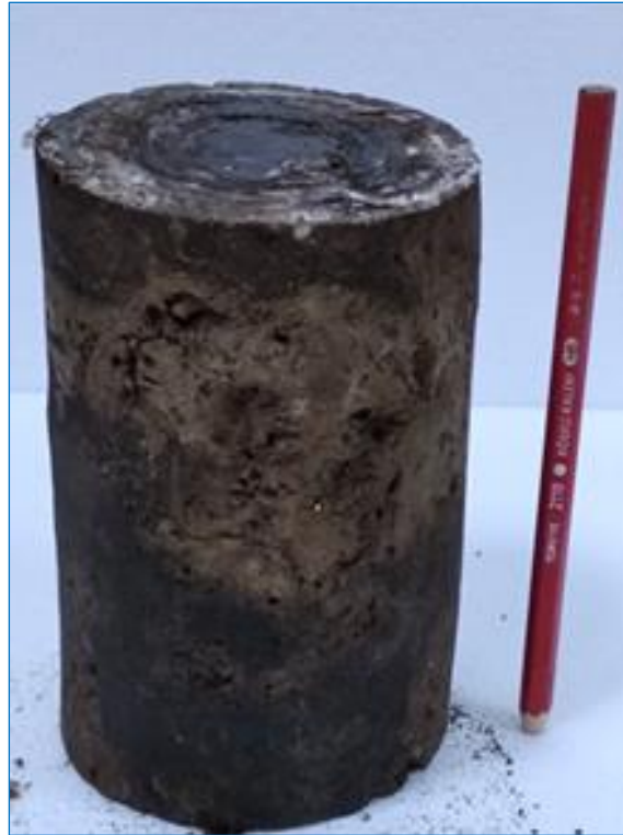
řekil 3. 22. Karot teleme testi sonrası tam ap karot
