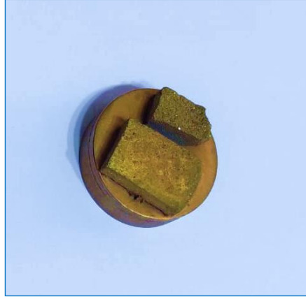
Şekil 3. 19. 257 no'lu tapanın SEM ve EDS çekimleri için hazırlanmış numunesi
