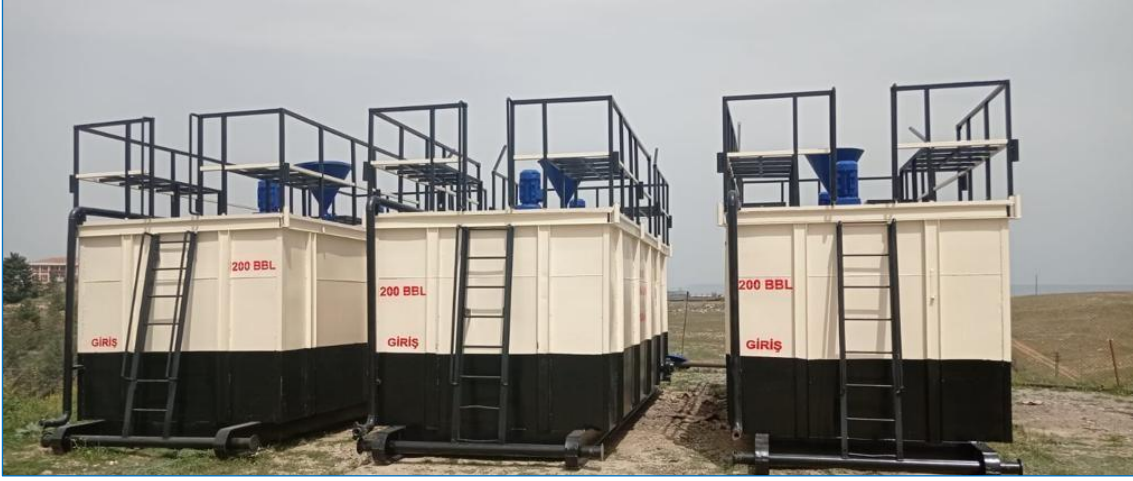
Şekil 3. 32. Operasyonda kullanılan 200 bbl'lik mikserli tanklar
