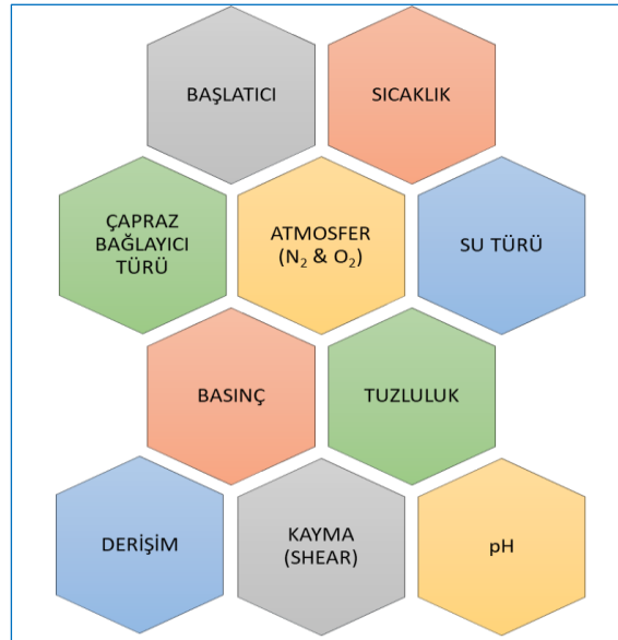
Şekil 3. 7. Rezervuarda polimerizasyonu ve jelleşmeyi etkileyebilecek faktörler
