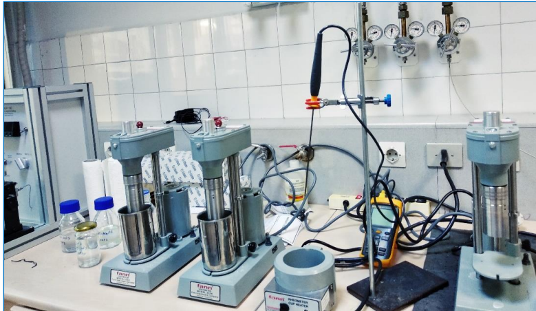
Şekil 3. 14. İntrinsik viskozite ölçümünde kullanılan Fann 35SA model viskozimetre
