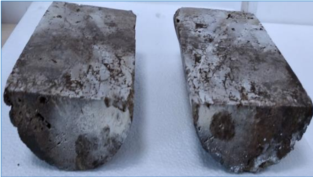
Şekil 4. 32. Öteleme Testi'nde kullanılan tam çap karotun test sonrası yarılanmış hali
