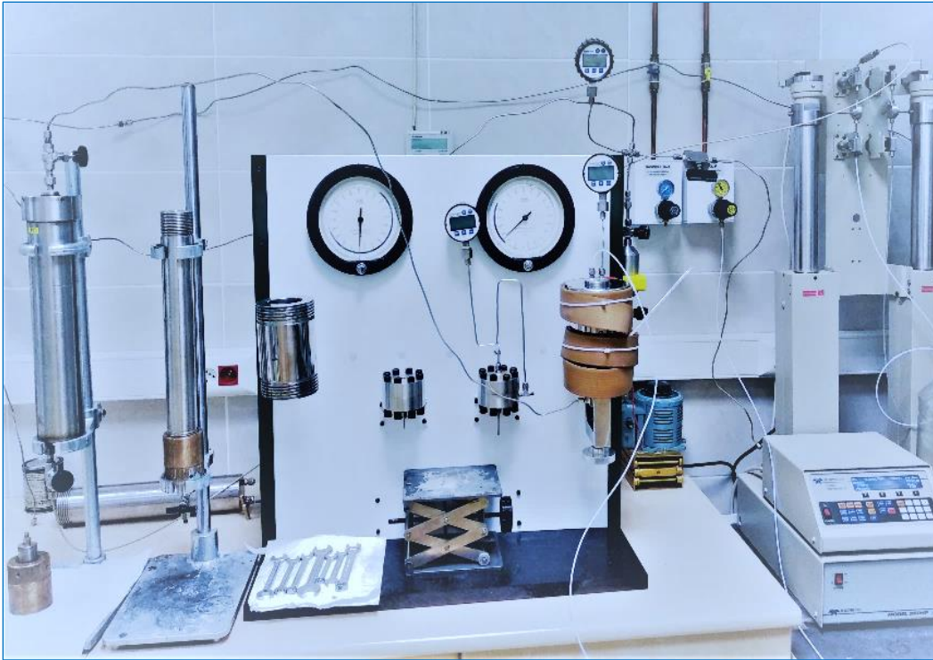
Şekil 4. 22. Akış Test Sistemi'nde yürütülen tapalarda akış testi
