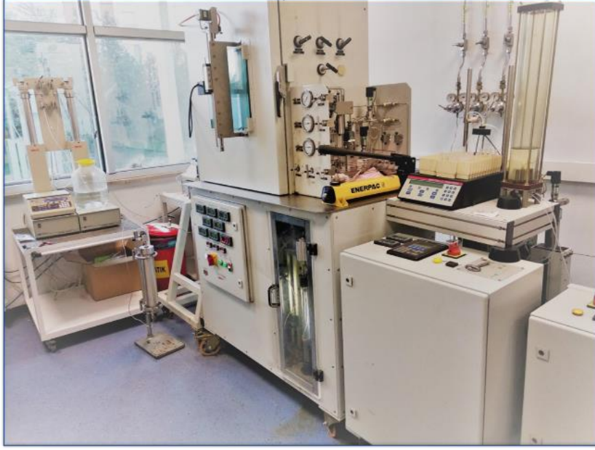
Şekil 3. 20. VINCI CFS 700 model Karot Öteleme Test Sistemi
