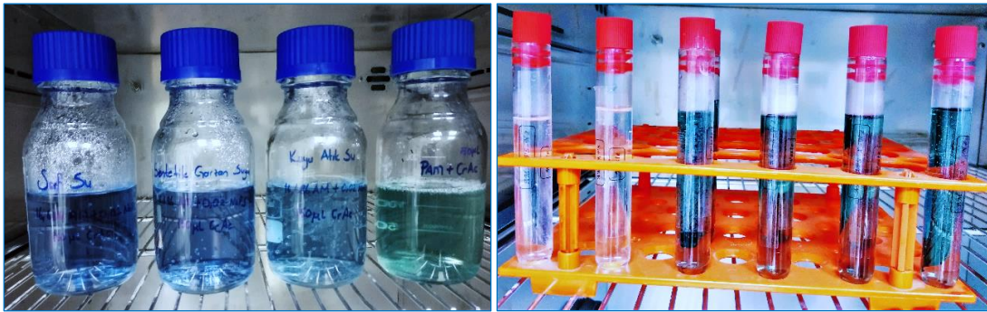
Şekil 4. 5. Statik koşullarda, Monomer + Başlatıcı + Çapraz Bağlayıcı Deneyleri
