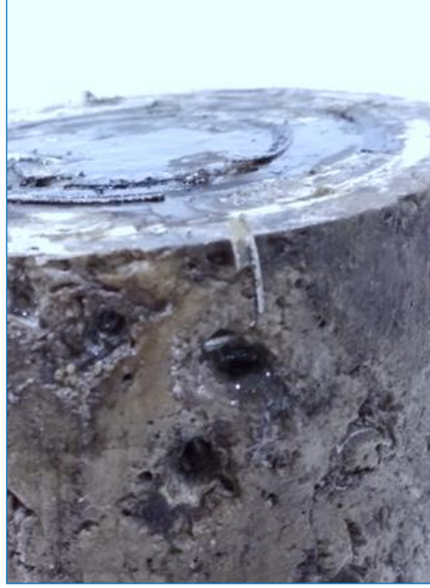
Şekil 4. 31. Öteleme Testi'nde kullanılan tam çap karotun test sonrası durumu
