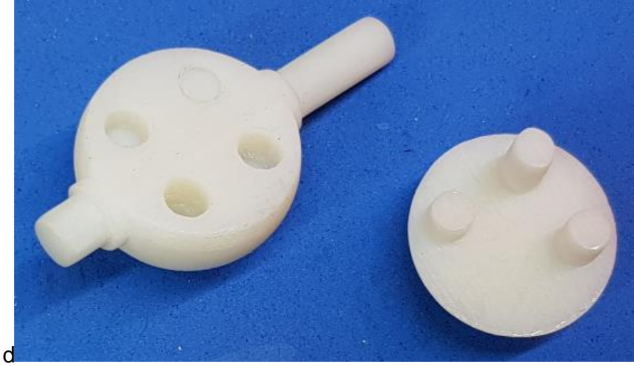
Şekil 3.13. İki parçadan oluşan ABS plastik göz küresi
