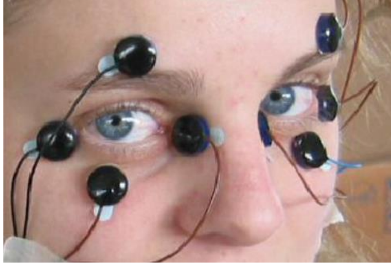
Şekil 2.16. EOG ile göz hareketi ölçümü [58]
