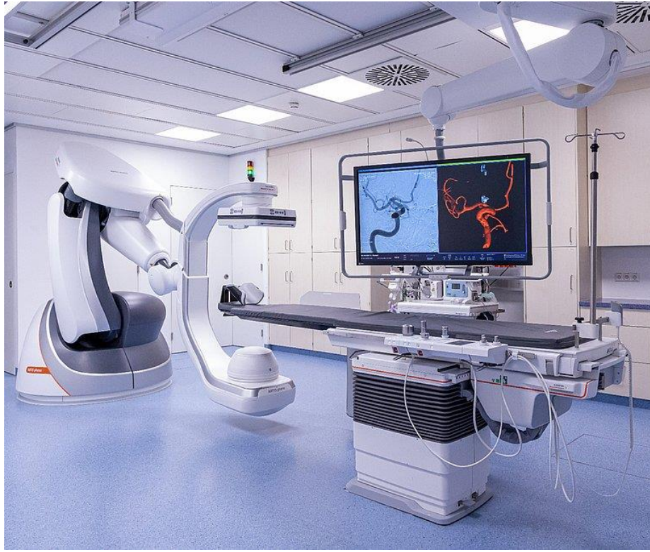
Şekil 3.2.1. Biplane flat-panel anjiyografi ünitesi (DynaCT) [55]
