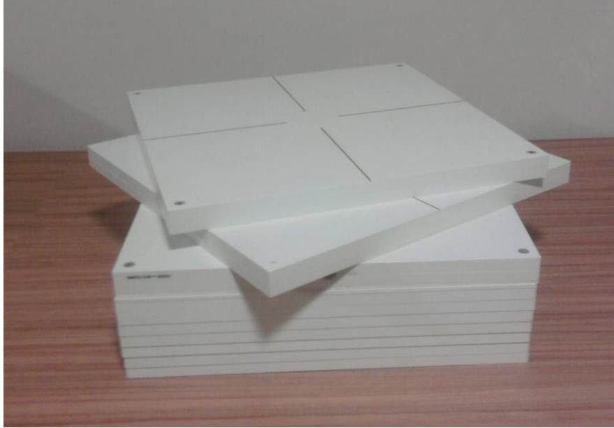
řekil 3.7. PTW marka RW3 katı fantom.
