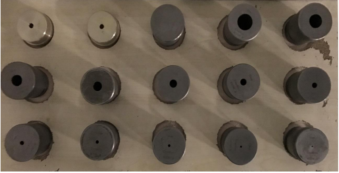
Şekil 2.2. Silindirik kolimatörler, çapları 5 - 60 mm aralığında değişmektedir.
