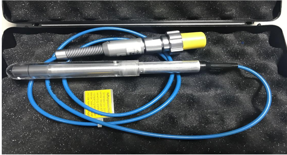
Şekil 3.8. 30013 PTW 0,6 cc iyon odası.
