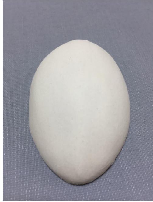
Resim 2.42: 1200°C de pişirilmiş deneme
