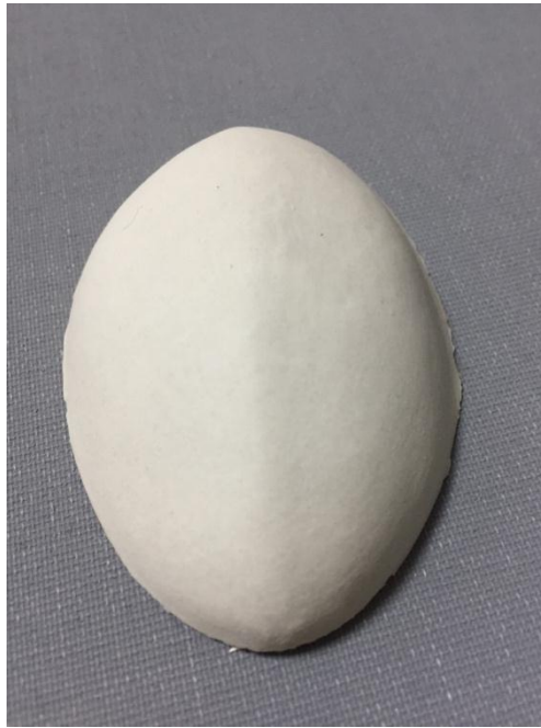
Resim 2.63: 1250°C de pişirilmiş deneme
