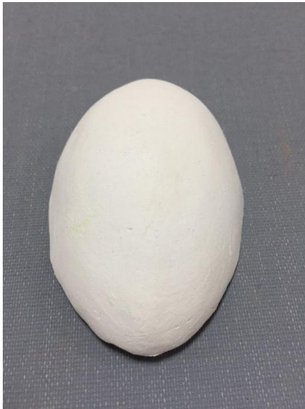
Resim 2.9: 1050°C de pişirilmiş deneme
