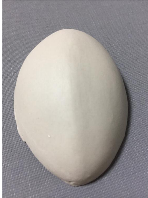
Resim 2.48: 1250°C de pişirilmiş deneme
