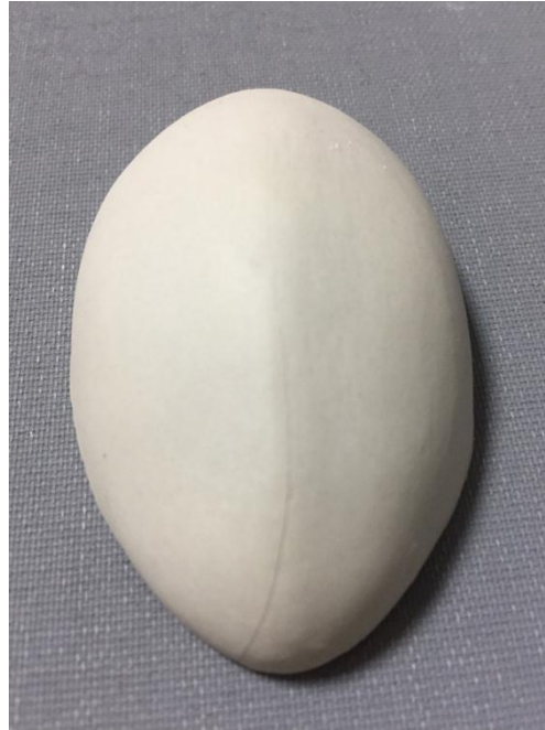
Resim 2.43: 1250°C de pişirilmiş deneme
