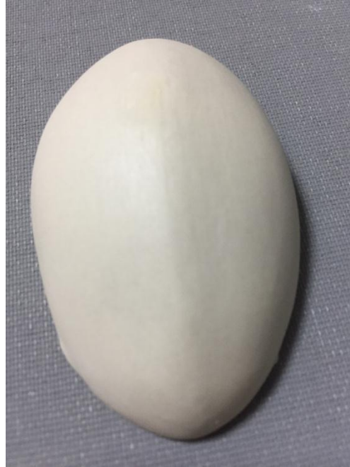
Resim 2.53: 1250°C de pişirilmiş deneme
