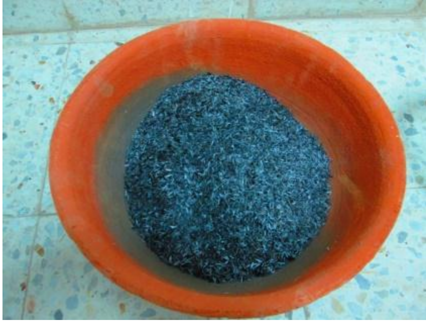
Resim 2.7: Kalsinasyon sonrası pirinç kabuklarının görünümü
