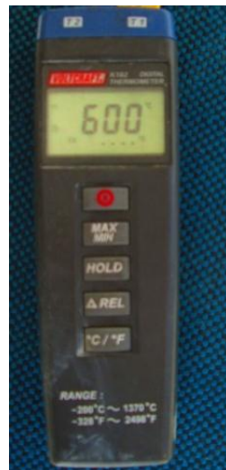
Resim 2.6: Sıcaklık ölçümünde kullanılan ısı ölçer (termokupl)
