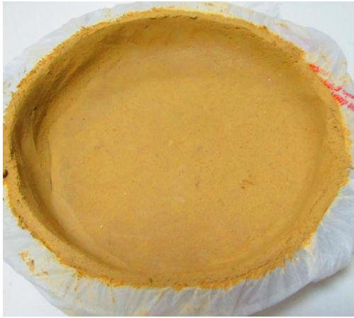
Resim 2.1: Kalsinasyon için hazırlanmış yaş şamot kap
