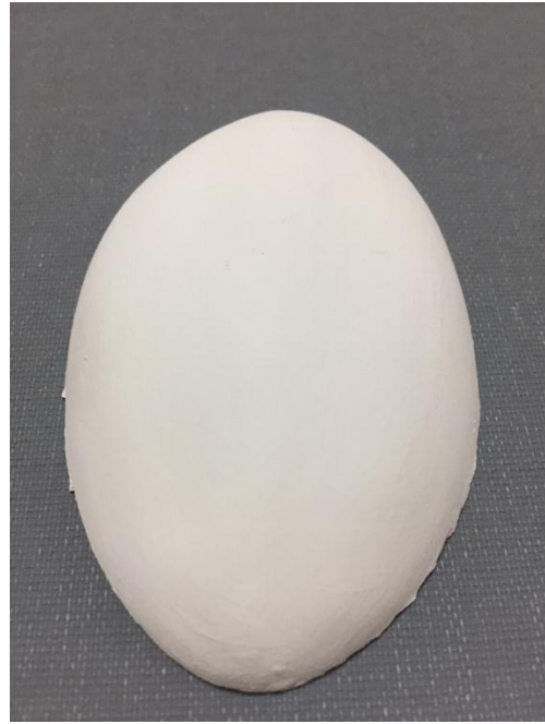
Resim 2.20: 1100°C de pişirilmiş deneme
