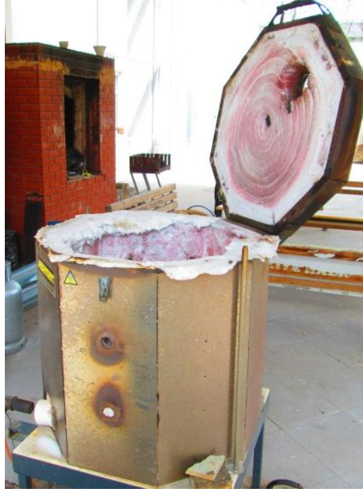
Resim 2.5: Kasinasyon işleminin yapıldığı gazlı fırın
