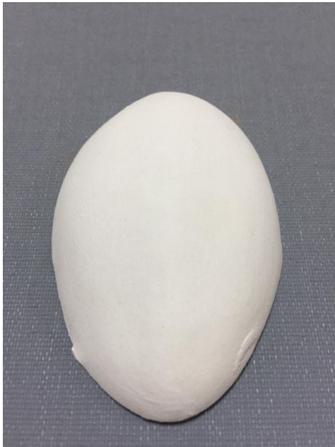
Resim 2.14: 1050°C de pişirilmiş deneme
