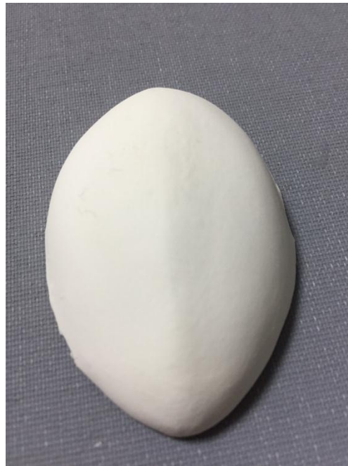
Resim 2.38: 1250°C de pişirilmiş deneme
