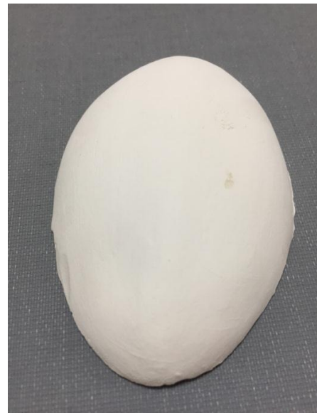
Resim 2.10: 1100°C de pişirilmiş deneme
