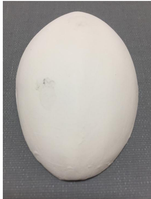
Resim 2.15: 1100°C de pişirilmiş deneme
