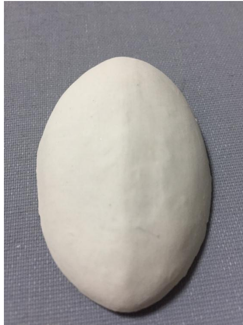
Resim 2.28: 1250°C de pişirilmiş deneme
