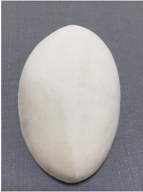
Resim 2.19: 1050°C de pişirilmiş deneme
