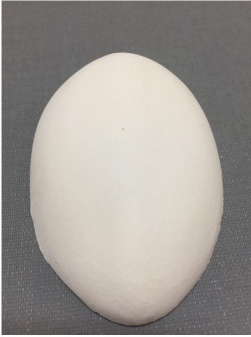
Resim 2.41: 1150°C de pişirilmiş deneme
