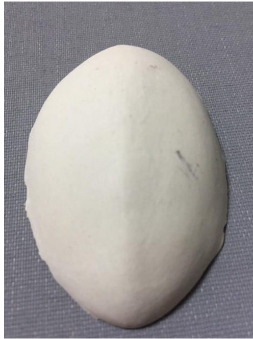
Resim 2.23: 1250°C de pişirilmiş deneme
