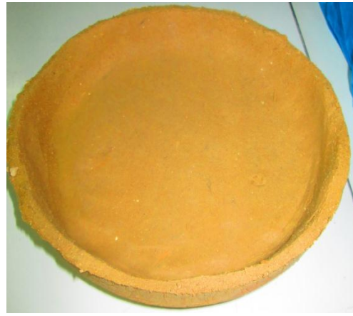
Resim 2.2: Kalsinasyon için hazırlanmış kuru şamot kap
