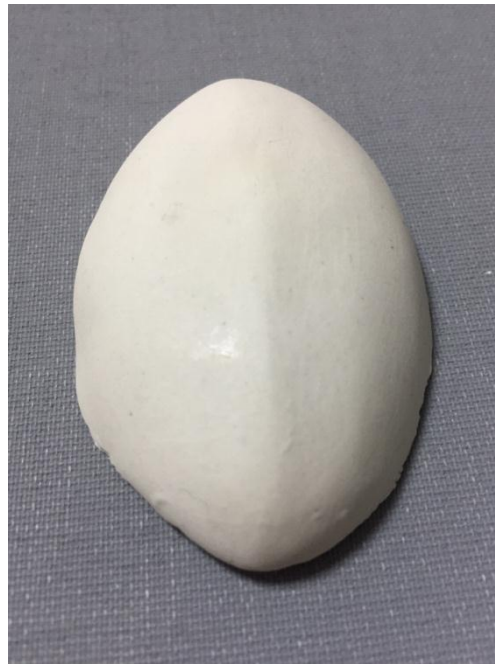
Resim 2.13: 1250°C de pişirilmiş deneme
