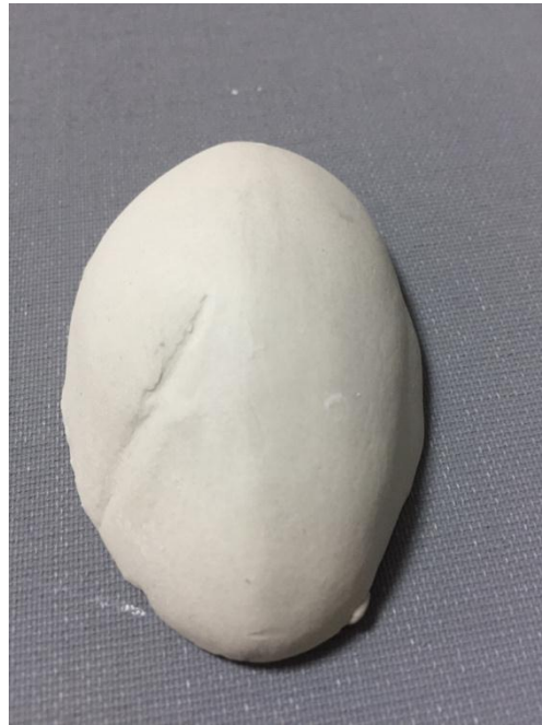
Resim 2.58: 1250°C de pişirilmiş deneme
