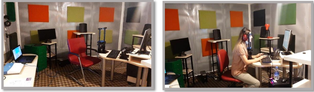
Şekil 5. Dinleme çabasının değerlendirilmesinde kullanılan test düzeneği
