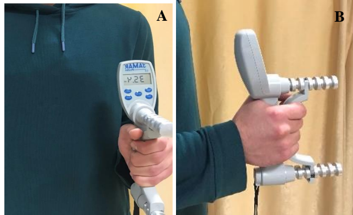
Şekil 3.6 Dinamometre kullanarak standart kavrama kuvveti ölçümü (A. Önden görünüm, B.Lateralden görünüm)
