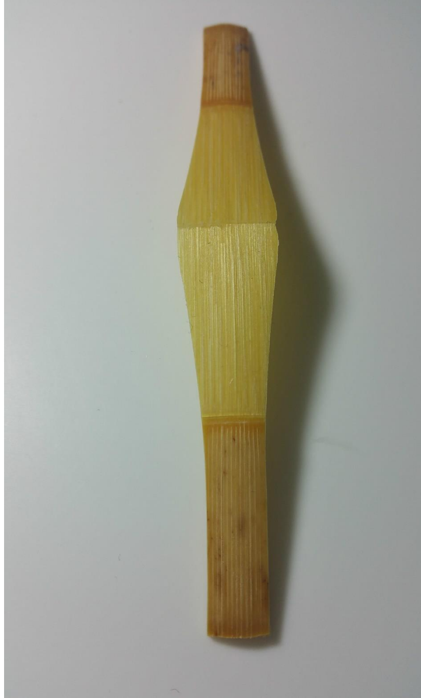
Şekil 14 Georg Rieger marka 1A model forma ile şekil verilmiş kargı.
