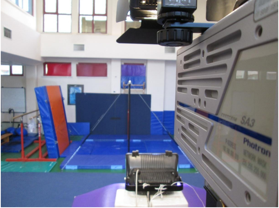
Şekil 3.10: Deney düzeneğinde barfiks ve kameranın yerleşimi.
