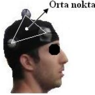
Şekil 3.15: Kafayı tanımlamak için kullanılan yansıtıcı işaretler ve orta nokta.
