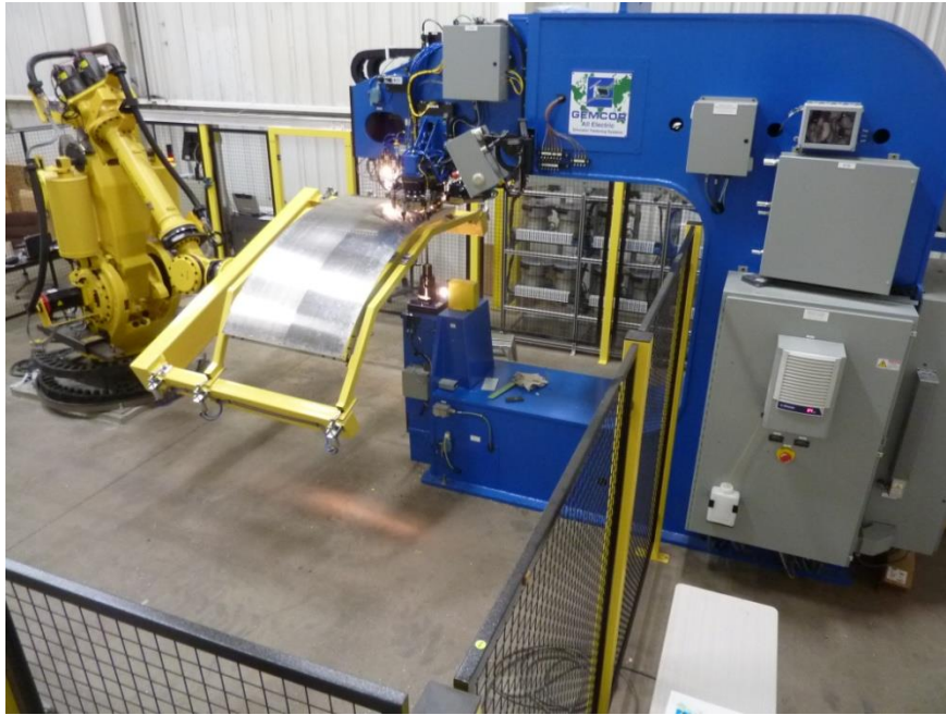
Şekil 3.9 Ramp door perçin tezgâhı [35]
