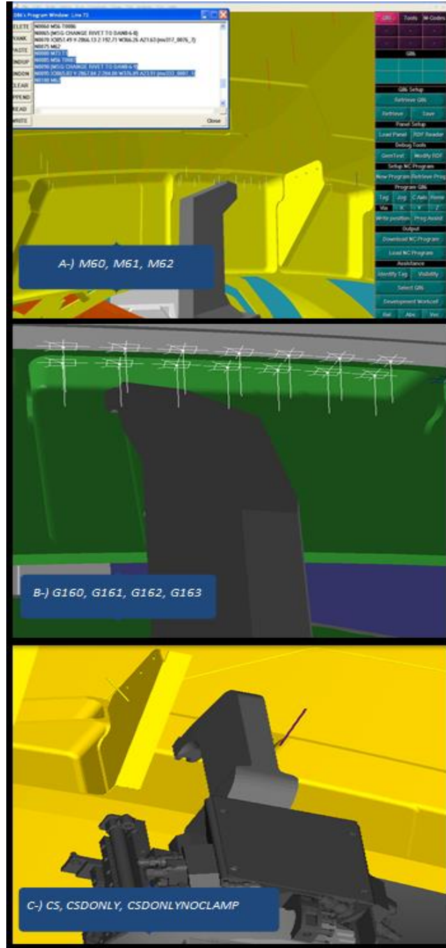
Şekil 6.15 Delme ve perçinleme komutları
