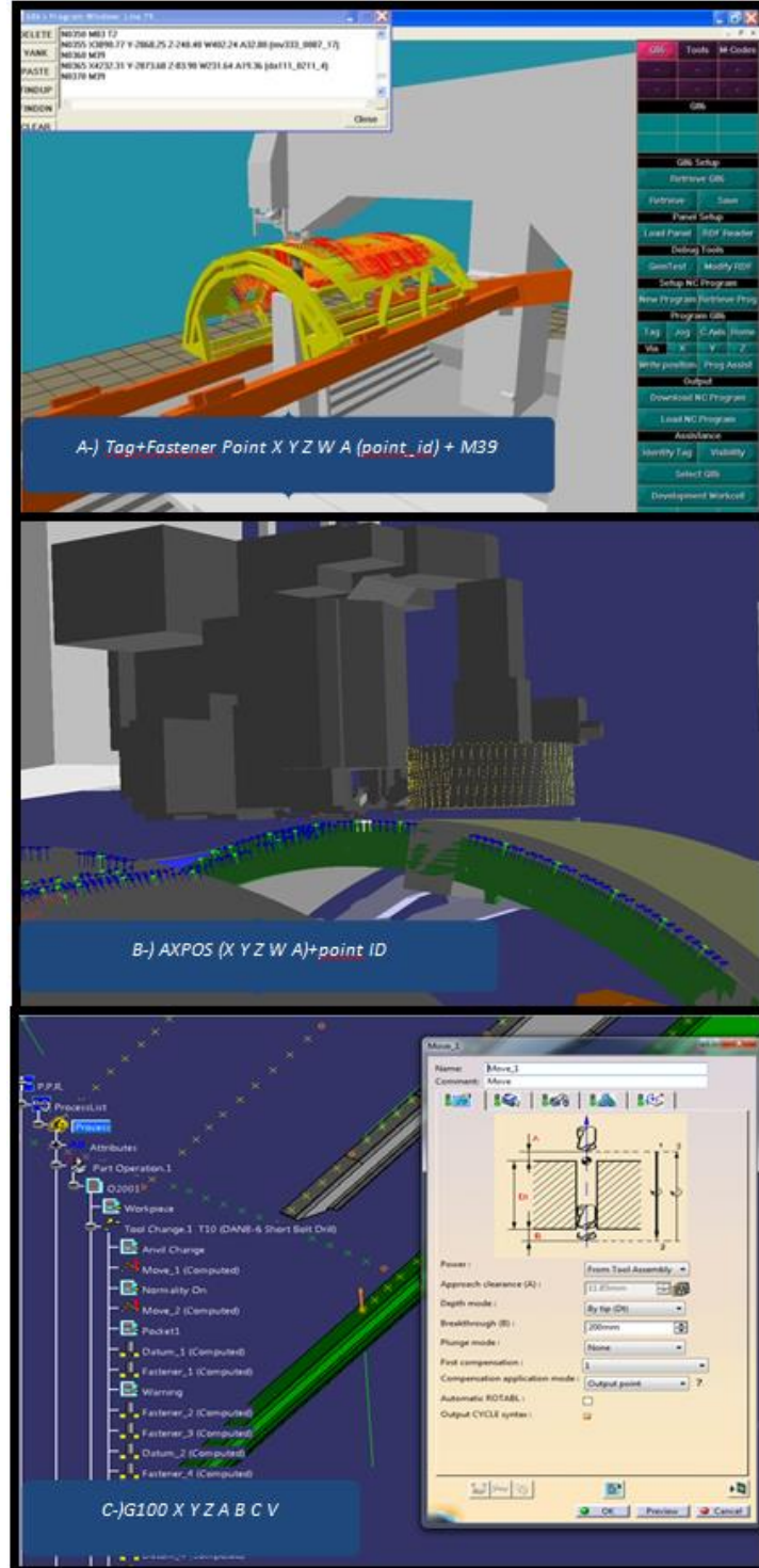
Şekil 6.7 Tezgâh eksen hareketleri komutu
