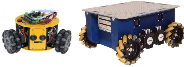
Şekil 3.9: Çok yönlü platformlar Üç tekerli 90° rulolu (A), Dört tekerli ve 45° rulolu (B) . [29-30]
