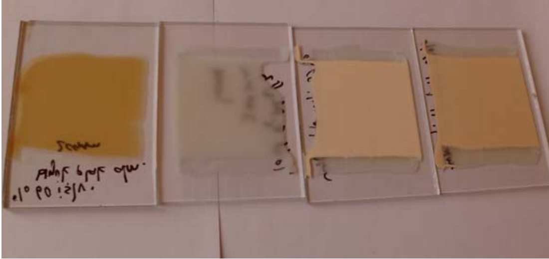
Şekil 4.24 İşlevsel alüminalarla cam üstünde hazırlanan kaplamalar (soldan sağa): nano alümina, ticari alümina, iğne alümina, plaka alümina
