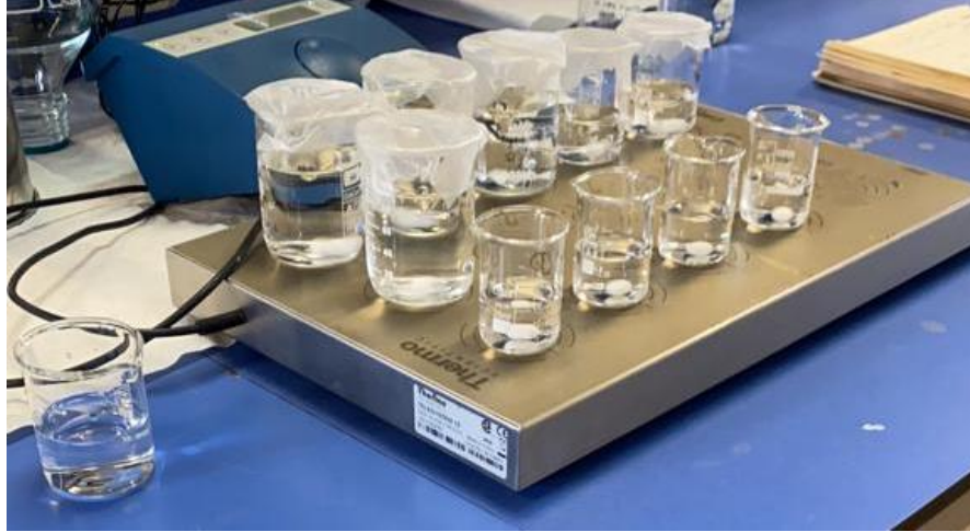
Şekil 16. Manyetik karıştırıcı üzerinde, farklı deney setlerine ait, TPP ve kitosan içeren solüsyonlar.
