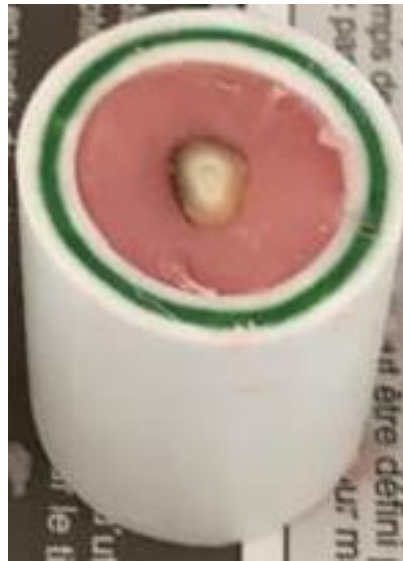
Şekil 10. Örneklerin akrilik rezin içine gömülmesi.
