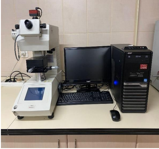
Şekil 23. A) Mikrosertlik cihazı, B) Yük uygulandıktan sonra dentinin görüntüsü.
