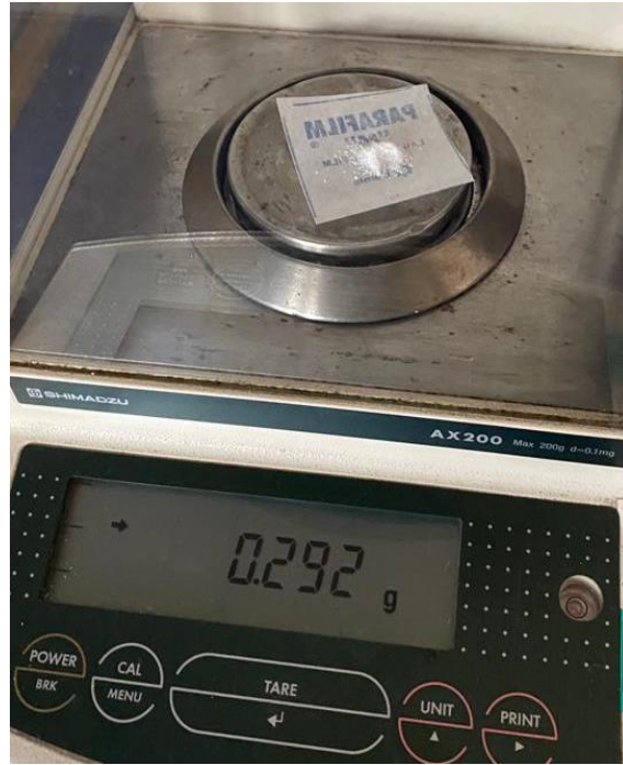
Şekil 13. Hassas tartıda NaCl miktarının ölçümü.
