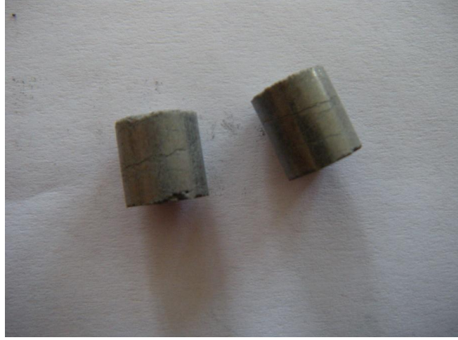
Şekil 4. 2. Presleme sonrasında yüzey çatlakları oluşmuş hacimce %50 Mg içeren numune.
