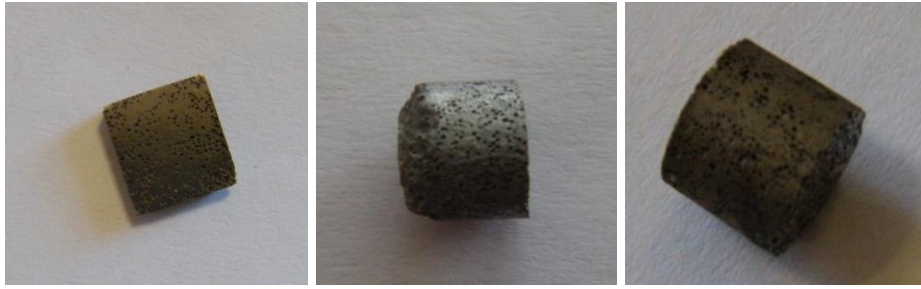
Şekil 4. 6. Boşluk tutucu ve geleneksel sinterleme tekniği ile gözenekli NiTi alaşımın üretim basamakları [1].
