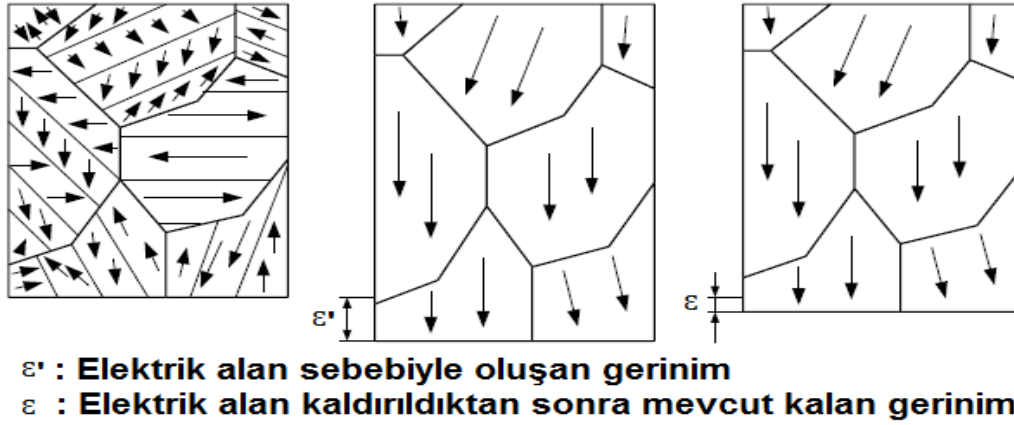
Şekil 8-Piezoseramiklerin kutuplanma işleminin şematik gösterimi (J.Brünahl 2003)
