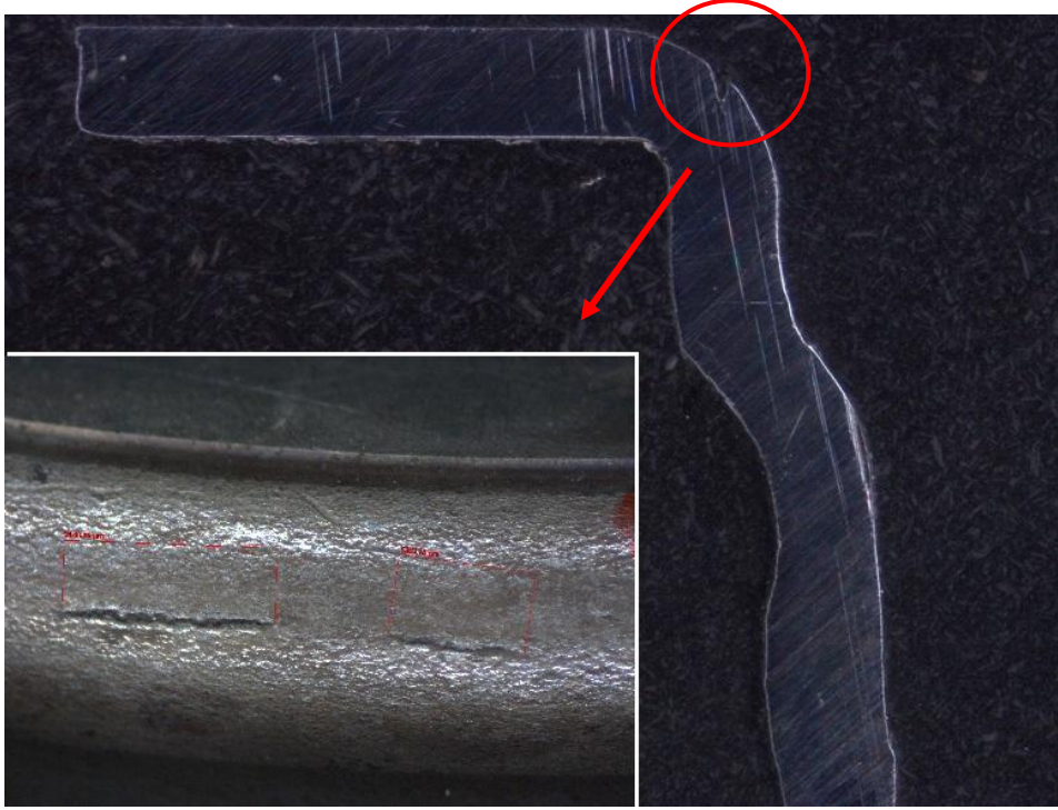
Şekil 1.8. Dış Bilezik Bükümü Görünüşü ve Kesitte Çatlak Örneği
